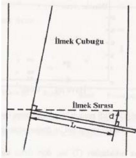
Şekil 2.15. May dönmesi ölçüm yöntemi (Tao ve ark. 1997 a)
