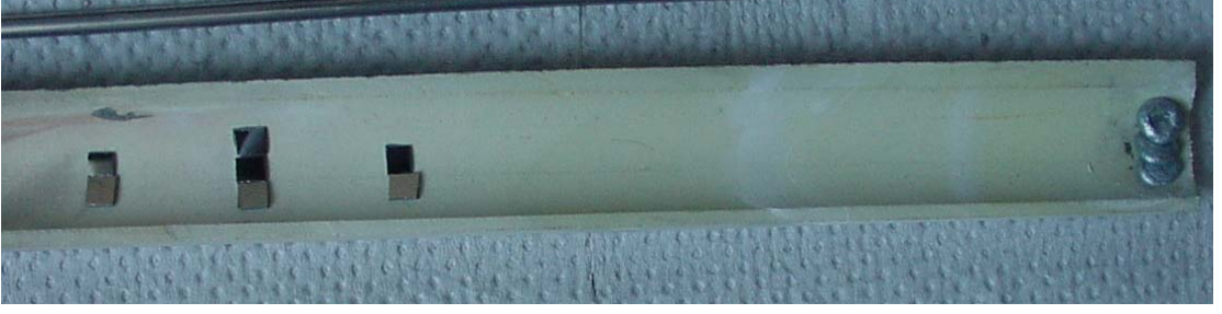
Şekil 3.2 Si(100) taşıyıcı ve Zn'nun içinde bulunduğu kayığın deney öncesi çekilen resmi
