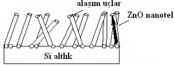
Şekil 2.9: Nanotel büyüme aşaması şematik gösterimi [3]
