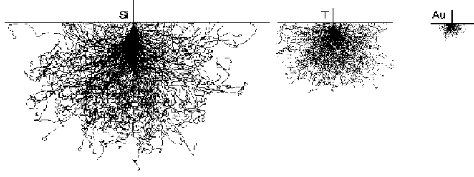
Şekil 2.20: Sağdan sola doğru artan atom sayısına göre etkileşim hacminin değişiminin Monte Carlo simülasyonu [21]
