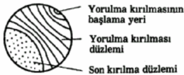
Şekil 2.1. Küçük gerilme altında dönen bir milin, yorulma kırılmasına uğraması halinde, kırılma yüzeyinin görünümü
