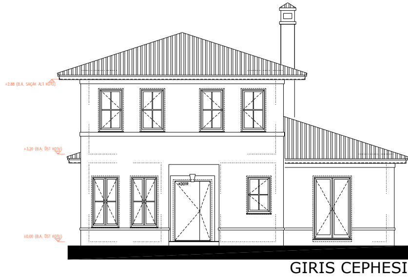
Şekil Ek-C.2: Yapı-2 ön ve giriş cephesi görünüşleri
