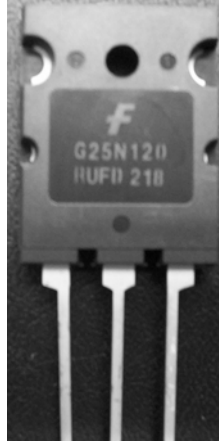
Fotoğraf 5.3 H-köprü devresinde kullanılan IGBT 'nin görüntüsü.
