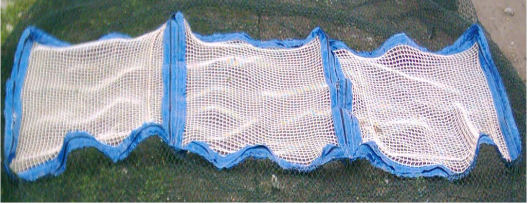
Şekil 4.1.3.1.3. Fermuar-Branda Sistemi ve Kare Gözlü penceredeki Paneller (Orijinal)
