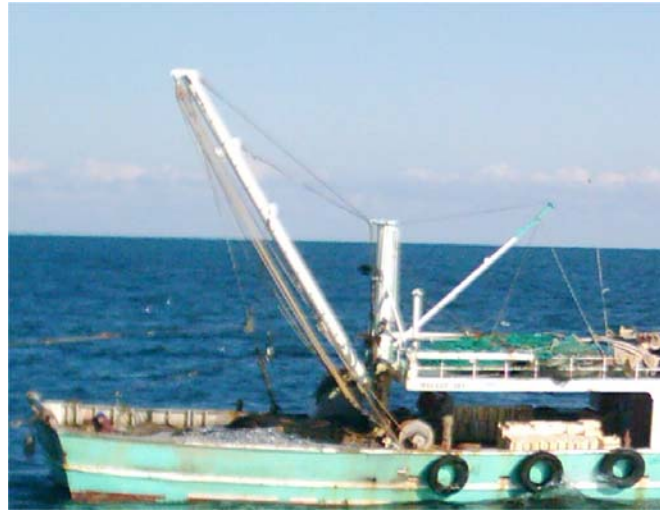
Şekil 2.3.1.2. Trol Teknesinin Direk Donanımı (Orijinal)
