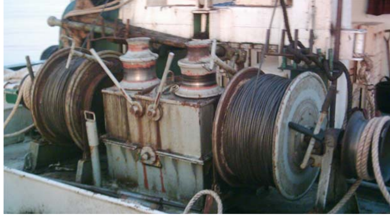
Şekil 2.3.1.1. Trol Irgatına Sarılı Trol Teli ile Fenerliğe Sarılı Palamar Halatı (Orijinal)
