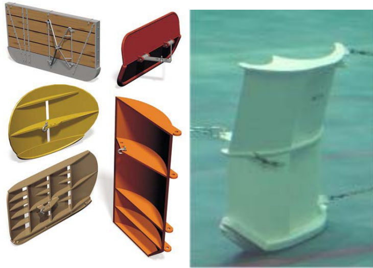
Şekil 2.3.1.4. Klasik ve modern trol kapısı tipleri (Anonim, 2006c)
