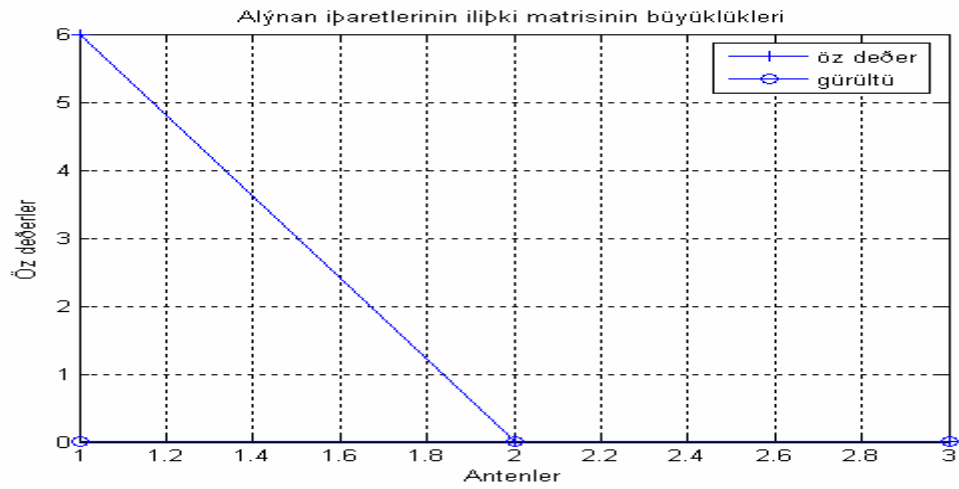
Şekil 6.30. SNR=100, sinyal sayısı 2, açıları (20, 21), anten sayısı 3, örnek sayısı 1000 ve farklı frekans değerleri için özdeğer ve gürültü tabanı grafiği
