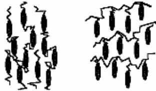
Şekil 1.13 Sıvı Kristal Polimerler: Ana zincir (sol) ve yan zincir (sağ) düzenlenmeleri [6].
