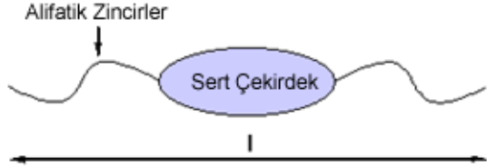
Şekil 1.14 Kalamitik sıvı kristallerin genel yapısı; l \gg b [8].
