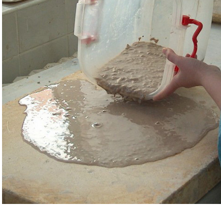
Resim 56. Kağıt katkılı bünyenin plastik hale getirilme aşaması I.
