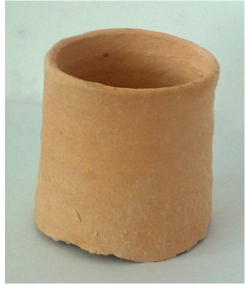
Resim 69. %6 Kağıt katkıli şamotlu bünyenin 1200°C'de pişmiş hali.
