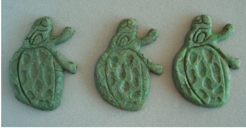
Resim 64. Cr 2 O 3 'le renklendirilmiş kağıt katkılı porselen bünyeler.
