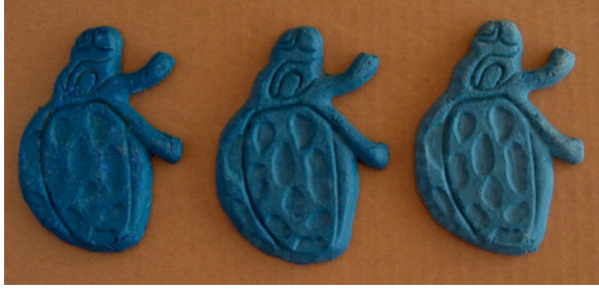
Resim 63. CoO'le renklendirilmiş kağıt katkılı porselen bünyeler.
