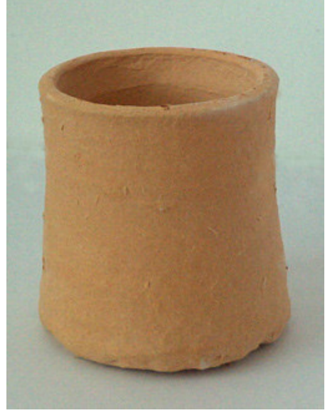
Resim 69. %6 Kağıt katkıli şamotlu bünyenin 1200°C'de pişmiş hali.
