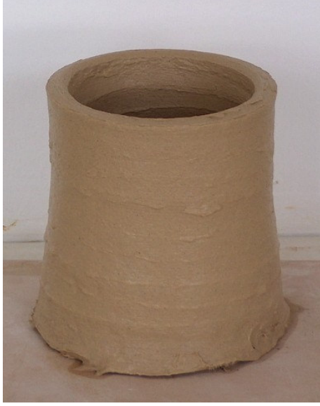
Resim 68. %6 Kağıt katkıli şamotlu bünyeye torna uygulaması.
