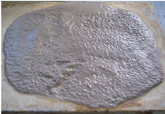
Resim 58. Kağıt katkılı bünyenin plastik hale getirilme aşaması III.
