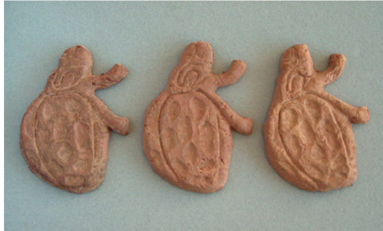
Resim 62. \text{Fe}_2\text{O}_3 'le renklendirilmiş kağıt katkılı şamot bünyeler.
