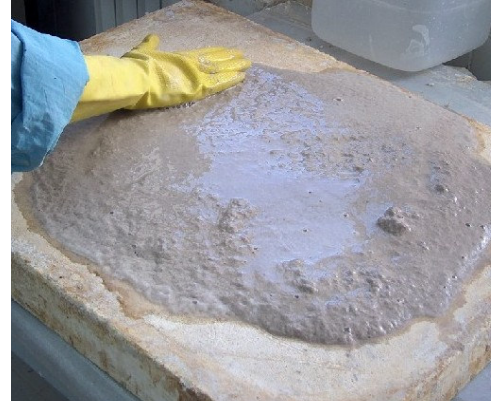
Resim 57. Kağıt katkılı bünyenin plastik hale getirilme aşaması II.
