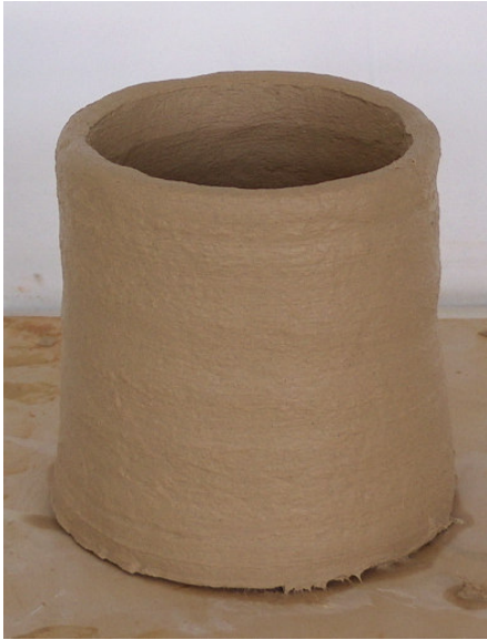
Resim 68. %6 Kağıt katkıli şamotlu bünyeye torna uygulaması.
