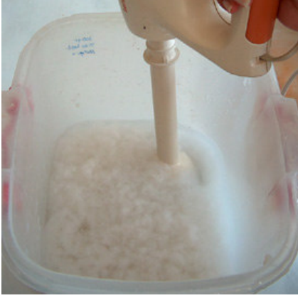
Resim 54. Seramik bünye ve kağıt hamurunun karıştırılma aşaması.
