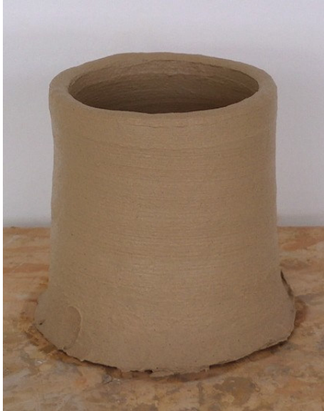
Resim 66. %4 Kağıt katkılı şamotlu bünyeye torna uygulaması.
