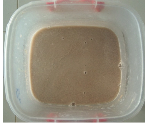
Resim 55. Homojen hale getirilmiş kağıt katkılı bünye.
