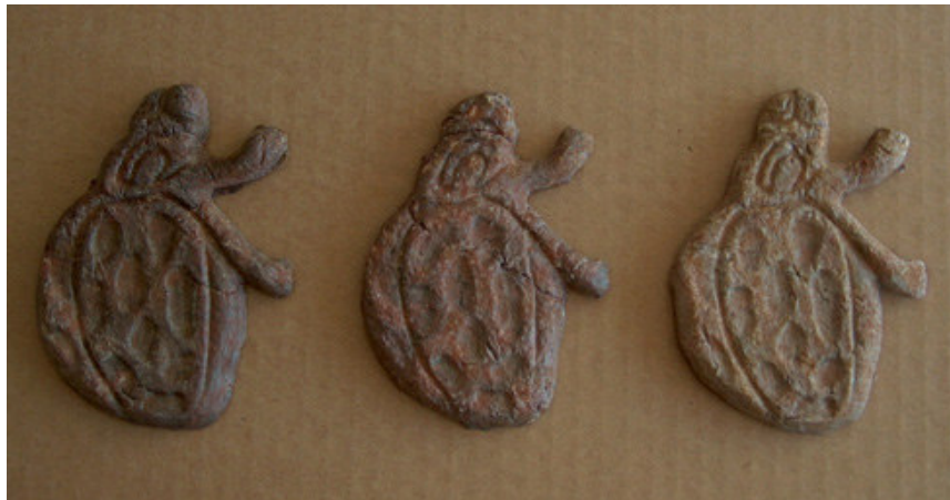
Resim 65. Fe 2 O 3 'le renklendirilmiş kağıt katkılı porselen bünyeler.
