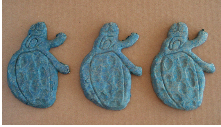
Resim 60. \text{CoO} 'le renklendirilmiş kağıt katkılı şamotlu bünyeler.
