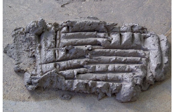
Resim 59. Plastik hale getirilmiş kağıt katkılı bünye.
