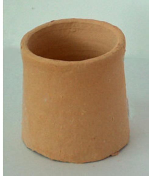
Resim 67. %4 Kağıt katkılı şamotlu bütynenin 1200°C’de pişmiş hali.
