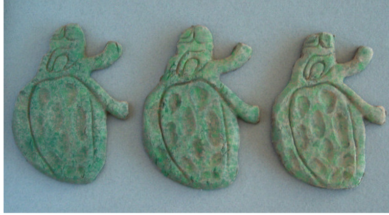
Resim 61. \text{Cr}_2\text{O}_3 'le renklendirilmiş kağıt katkılı şamotlu bünyeler.
