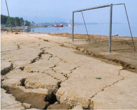
Şekil 4.11. (a) Başiskele kıyısındaki futbol sahasında meydana gelen yanal yayılmayla ilgili zemin deformasyonları ( http://peer.berkeley.edu/turkey ), (b) sahanın tez çalışması sırasında alınmış görüntüsü.
