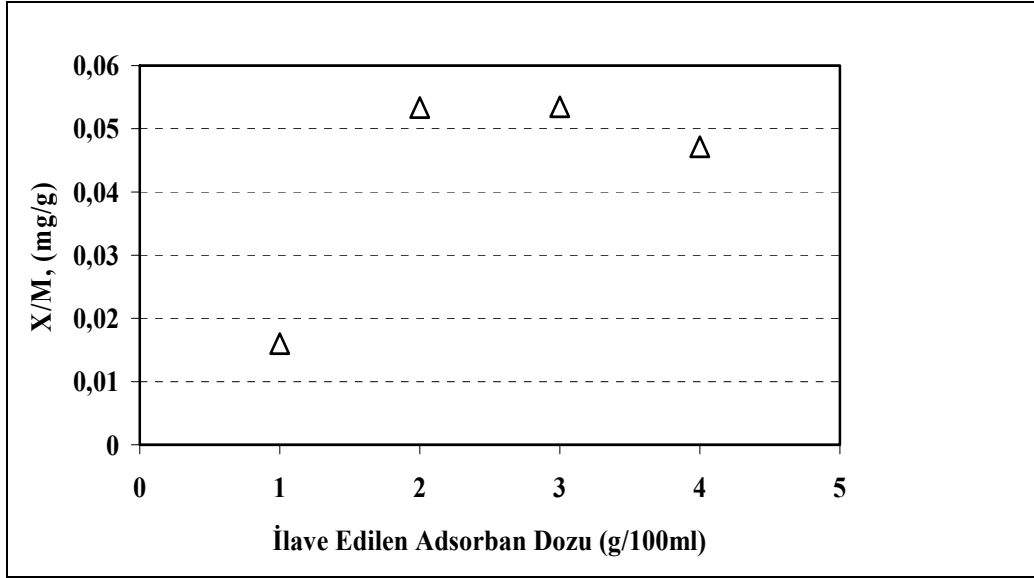
Şekil 5.4. İlave edilen adsorban dozuna bağlı olarak klinoptilolitin Pb^{+2} adsorplama kapasitesine etkisinin incelenmesi ( \Delta , giderilen Pb^{+2} miktarı mg/g klinoptilolit)
