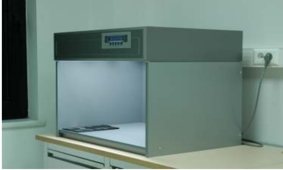
Şekil III.10. Değerlendirmede Kullanılan VeriVide Marka Renk Karşılaştırma Kabini
