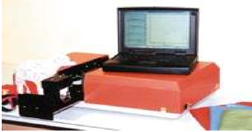
Şekil II.17. UV Nüfuz ve Koruma Sistemi
