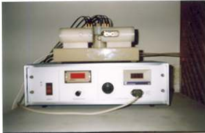
Şekil III.11. İşlemlerde Kullanılan P.A. HİLTON LTD. H940 Marka Isı Transfer Test Cihazı
