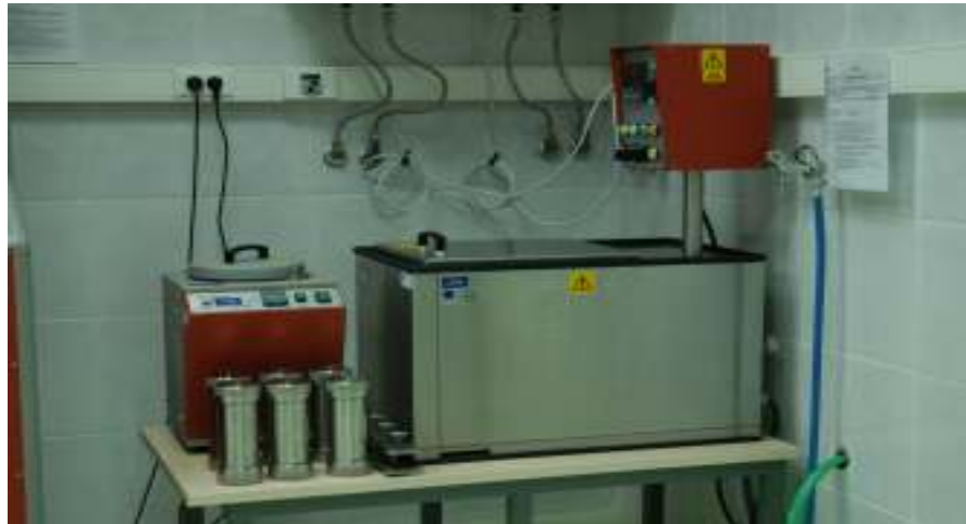
Şekil III.2. İşlemlerde Kullanılan SDL-ATLAS Marka Rotadyer (HT Boyama) Cihazı
