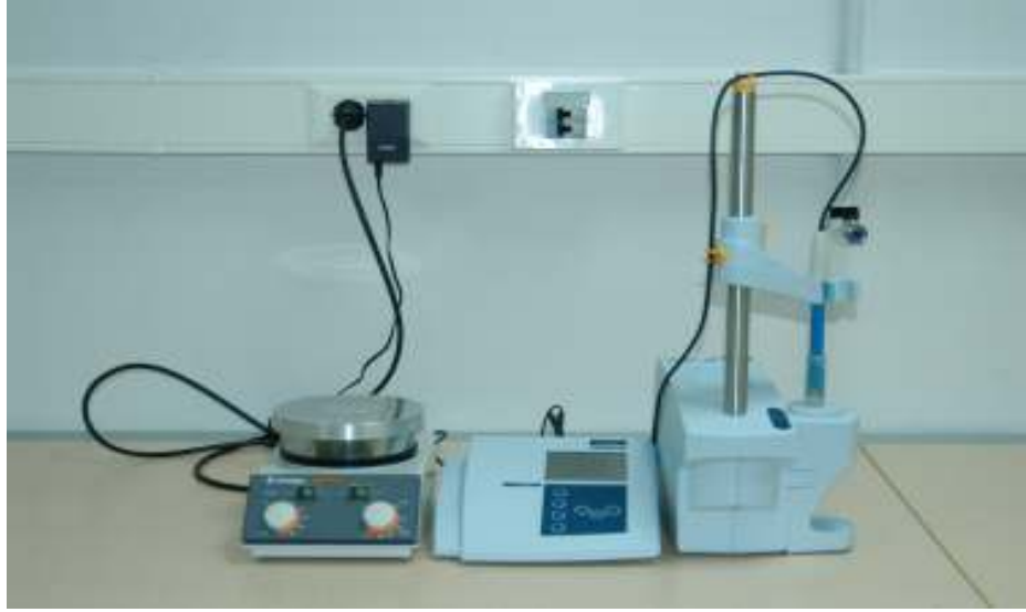
Şekil III.7. İşlemlerde Kullanılan INLAB Marka Dijital pH Metre ve WTW Marka Mıknatıslı Karıştırıcı – Isıtıcı
