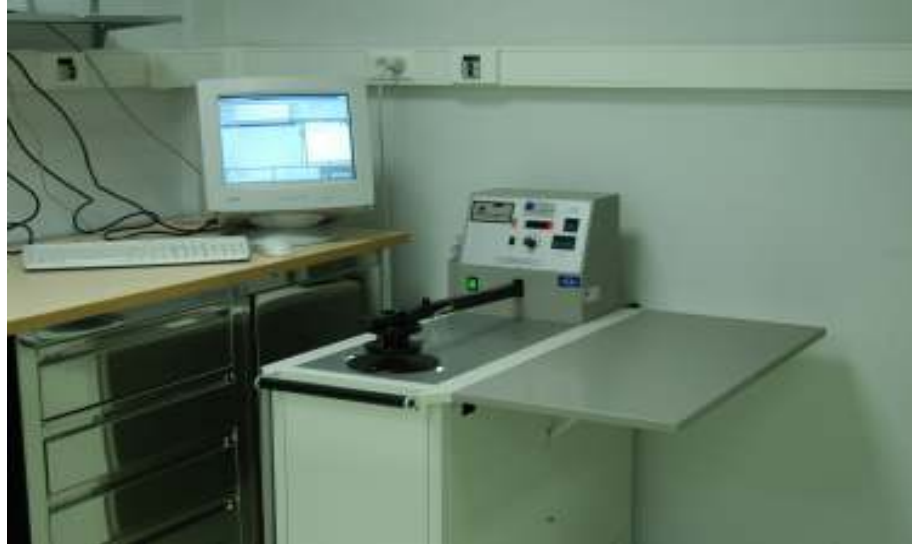
Şekil III.6. Testlerde Kullanılan SDL-ATLAS Marka Hava Geçirgenliği Test Cihazı
