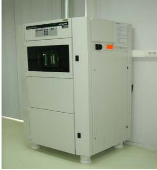
Şekil III.4. Testlerde Kullanılan SDL-ATLAS Marka Xenon Işığa Karşı Renk Haslığı Cihazı
