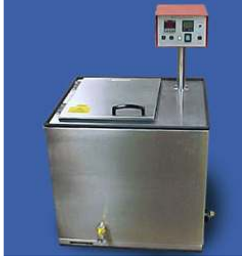
Şekil III.1. Testlerde Kullanılan SDL-ATLAS Marka Rotawash Cihazı
