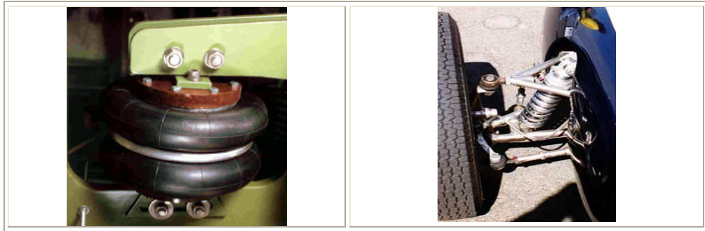
Resim 3.3. Darbe emici ve otomobil süspansiyonu [5]
