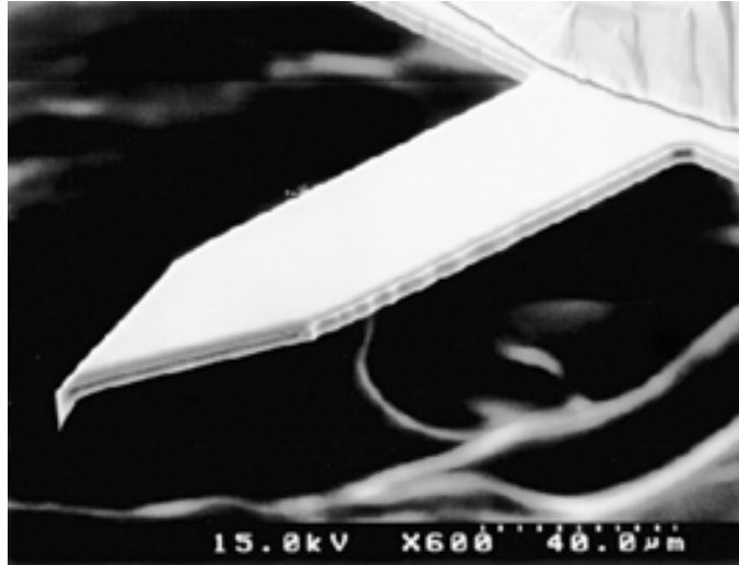
Şekil 3.21. AFM tekniğinde yüzeyi taramak için kullanılan denge çubuğu ve denge çubuğuna bağlı SiO 2 ince uç
