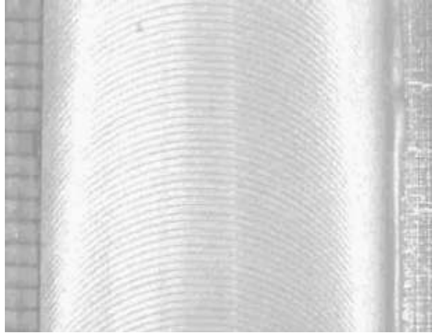
Şekil 4.2. SKK' da kaynak dikişinde oluşan soğan halkaları (Krishnan, 2002).
