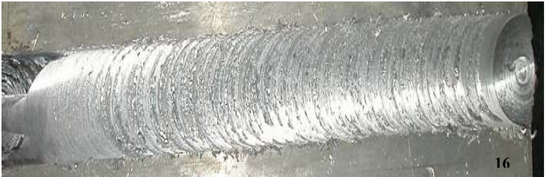
Şekil 6.4. Kaynak işlem parametrelerine bağlı olarak dikiş profilleri n: 630 dev/dk, 13: V:25 mm/dk, 14: V:50 mm/dk, 15: V:100 mm/dk, 16: V:125 mm/dk
