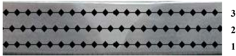
Şekil 5.5. Mikrosertlik ölçümlerinin yapıldığı noktaların şematik gösterimi (1: taban, 2: merkez, 3: üst)
