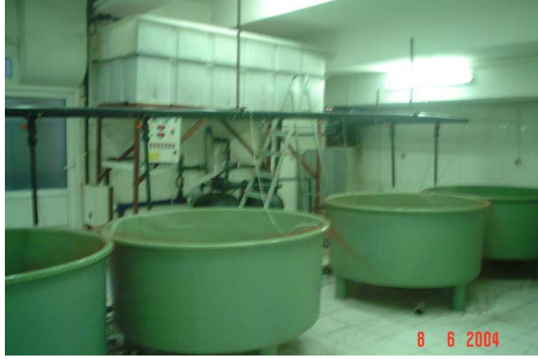
Şekil 3.5. Denemede kullanılan PVC tankları ve Kapalı Devre Sistemi
