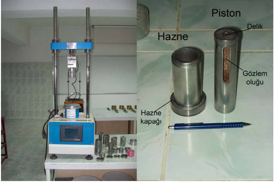
Şekil 3.11 Ters ekstrüzyon deneyinde kullanılan tek eksenli basınç aleti (solda) ile deneyde kullanılan hazne ve piston (sağda)
