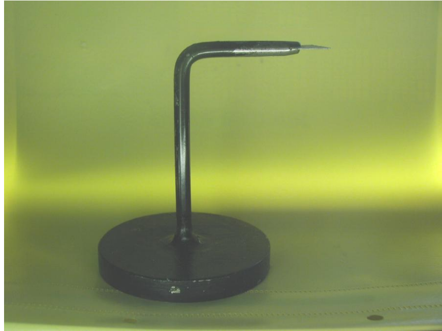
Resim 11: Braket kaidesinin sıyırma kuvvetine paralel olabilmesi için hazırlanan özel düzenek
