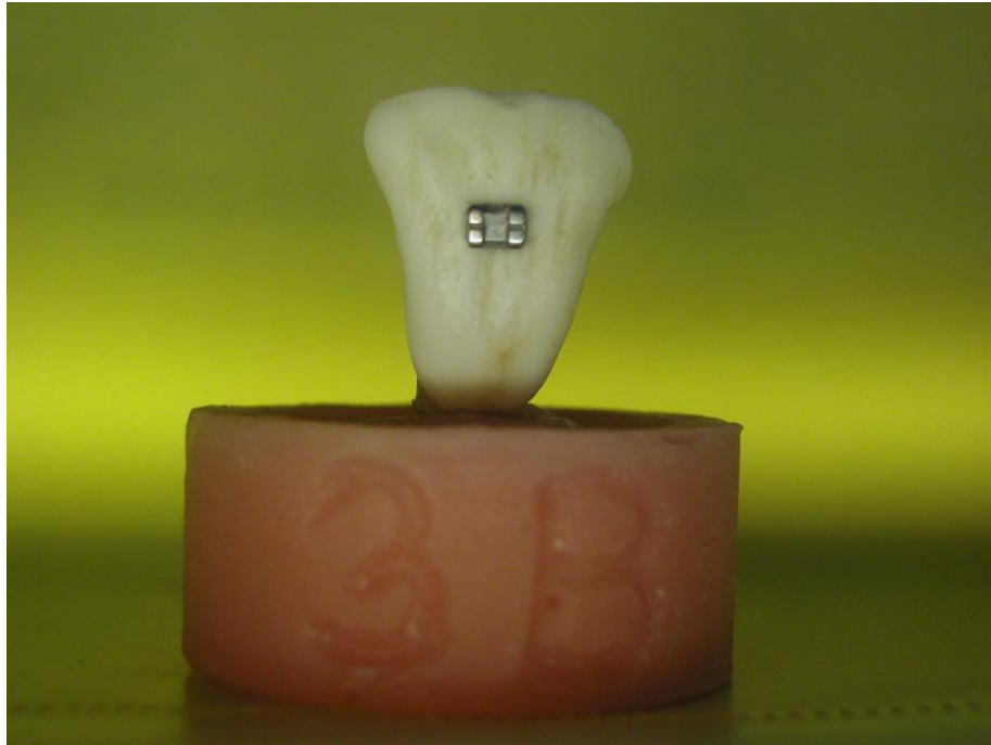
Resim 13: Akril bloklar içine alınmış ve test cihazına yerleştirilmeye hazır örnek.
