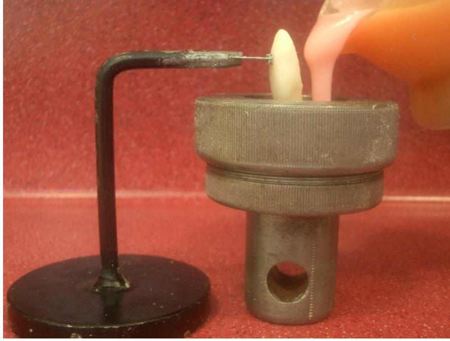
Resim 12: Braket yapıştırılan deney örneğinin akril blok içerisine alınması
