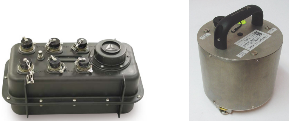
Şekil 3.2: Reftek kayıçısı (solda) ve Guralp 40T sismometre (sağda). ( http://www.guralp.com )
