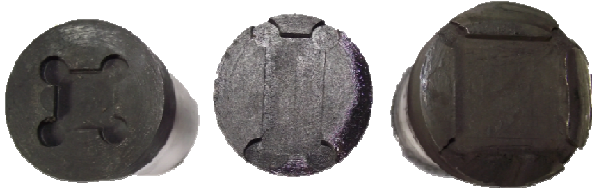
Resim 3.10 Alt sıradan sırasıyla 1", ½" ve ¼" ölçülerde balata numunesi tutucu pistonlar.
