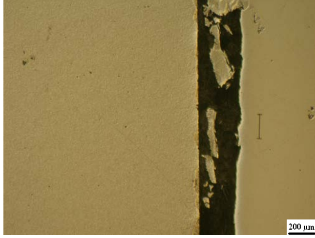
Şekil A.2.25: Ergimiş alüminyumda 4 saat bekletilmiş CrN kaplamalı H13.
