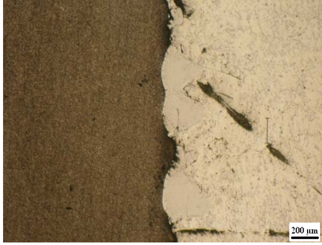
Şekil A.2.10: Ergimiş alüminyumda 4 saat bekletilmiş 15 µm borlanmış DIEVAR.
