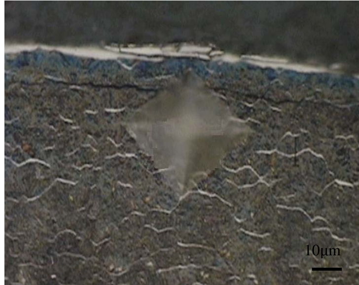
Şekil A.7.2: Nitrasyon uygulanmış H13 numunede kırılma tokluğu deneyinde oluşturulan çatlak görüntüsü.
