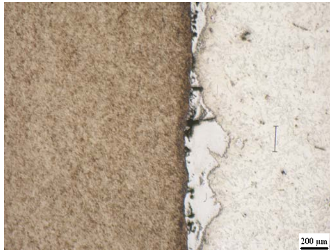
Şekil A.2.36: Ergimiş alüminyumda 6 saat bekletilmiş TiN/CrN kaplamalı H13.
