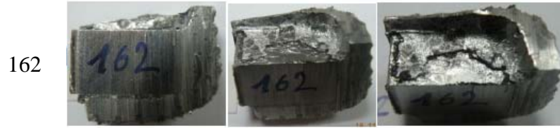
Şekil A.1.1: Isıl işlem görmüş DIEVAR çeliği numunelerde 4 (005), 6 (020) ve 8 (113) saat ergimiş alüminyum içerisinde bekleme sonucunda oluşan yapışma.
