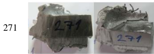
Şekil A.1.2: Isıl işlem görmüş H13 çeliği numunelerde 4 (162), 6 (164) ve 8 (271) saat ergimiş alüminyum içerisinde bekleme sonucunda oluşan yapışma.
