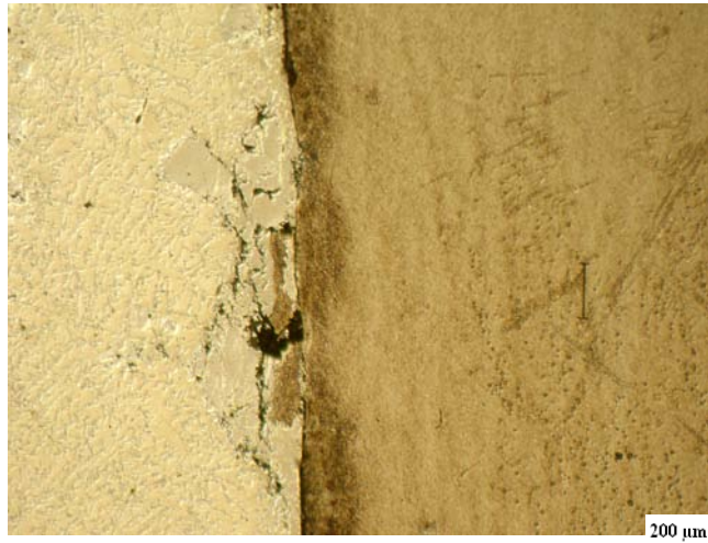
Şekil A.2.27: Ergimiş alüminyumda 8 saat bekletilmiş CrN kaplamalı H13.
