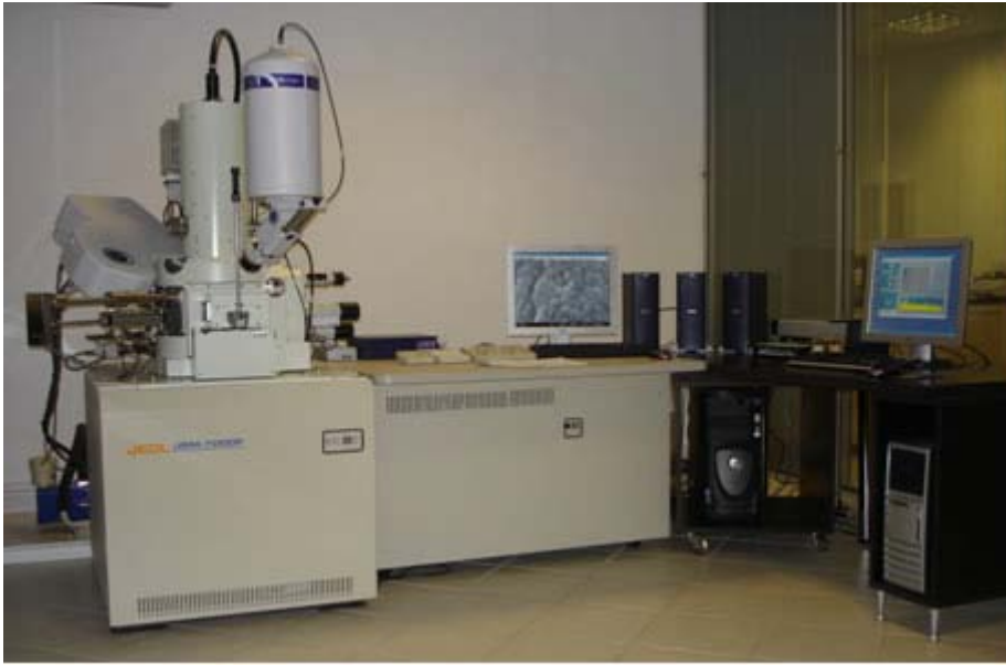
Şekil 9.8: JEOL JSM 7000F alan emisyonlu tarama elektron mikroskobu [37].
