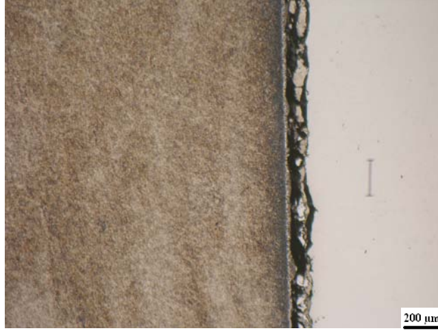
Şekil A.2.13: Ergimiş alüminyumda 4 saat bekletilmiş 43µm borlanmış DIEVAR.
