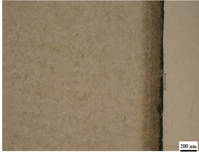
Şekil A.2.8: Ergimiş alüminyumda 6 saat bekletilmiş CrN kaplamalı DIEVAR.
