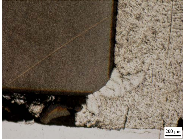
Şekil A.2.11: Ergimiş alüminyumda 6 saat bekletilmiş 15µm borlanmış DIEVAR.
