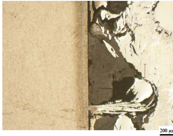
Şekil A.2.17: Ergimiş alüminyumda 6 saat bekletilmiş TiN/CrN kaplamalı DIEVAR.
