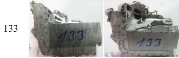
Şekil A.1.1: Isıl işlem görmüş DIEVAR çeliği numunelerde 4 (005), 6 (020) ve 8 (113) saat ergimiş alüminyum içerisinde bekleme sonucunda oluşan yapışma.
