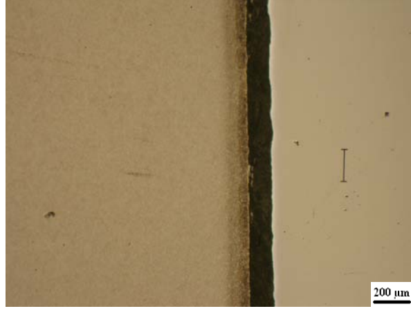
Şekil A.2.16: Ergimiş alüminyumda 4 saat bekletilmiş TiN/CrN kaplamalı DIEVAR.
