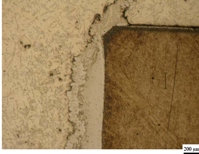
Şekil A.2.29: Ergimiş alüminyumda 6 saat bekletilmiş 15µm borlanmış H13.
