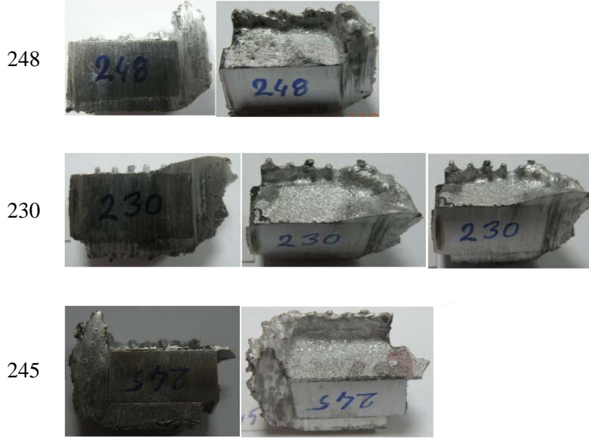
Şekil A.1.8: 15µm borlanmış H13 çeliği numunelerde 4 (248), 6 (230) ve 8 (245) saat ergimiş alüminyum içerisinde bekleme sonucunda oluşan korozyon yapısı.
