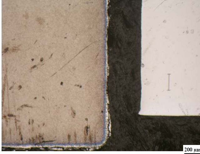
Şekil A.2.14: Ergimiş alüminyumda 6 saat bekletilmiş 43µm borlanmış DIEVAR.
