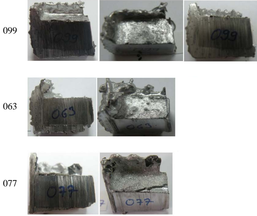
Şekil A.1.7: 15µm borlanmış DIEVAR çeliği numunelerde 4 (099), 6 (063) ve 8 (077) saat ergimiş alüminyum içerisinde bekleme sonucunda oluşan korozyon yapısı.
