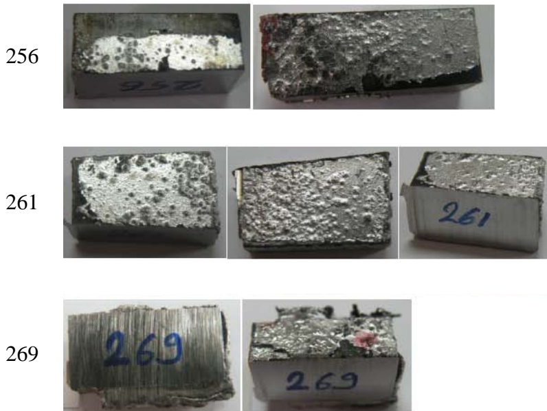
Şekil A.1.12: TiN/CrN kaplanmış H13 çeliği numunelerde 4 (256), 6 (261) ve 8 (269) saat ergimiş alüminyum içerisinde bekleme sonucunda oluşan korozyon yapısı.
