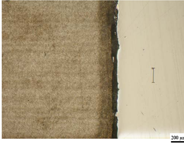
Şekil A.2.23: Ergimiş alüminyumda 6 saat bekletilmiş nitrasyonlu H13.
