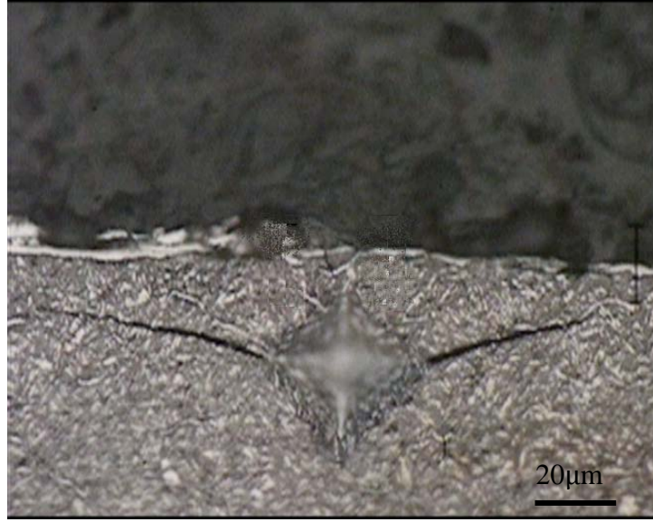
Şekil A.7.1: Nitrasyon uygulanmış Dievar numunede kırılma tokluğu deneyinde oluşturulan çatlak görüntüsü.
