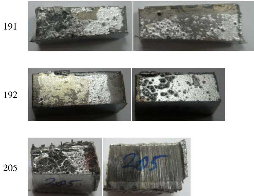
Şekil A.1.6: CrN kaplanmış H13 çeliği numunelerde 4 (191), 6 (192) ve 8 (205) saat ergimiş alüminyum içerisinde bekleme sonucunda oluşan korozyon yapısı.
