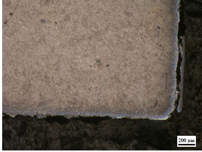
Şekil A.2.31: Ergimiş alüminyumda 4 saat bekletilmiş 43μm borlanmış H13.
