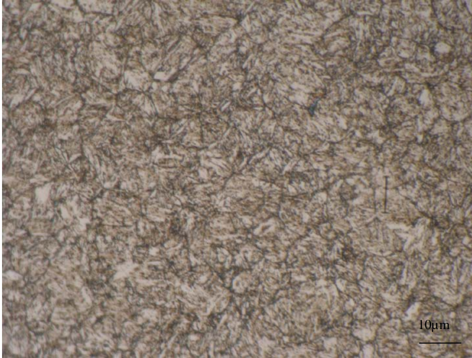
Şekil 9.1: Isıl işlem sonrası oluşan temperlenmiş martenzitik yapı.
