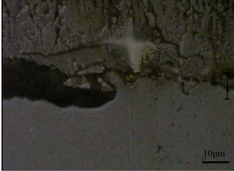
Şekil A.7.4: 43μm borlanmış numunede kırılma tokluğu deneyinde oluşturulan çatlak görüntüsü.
