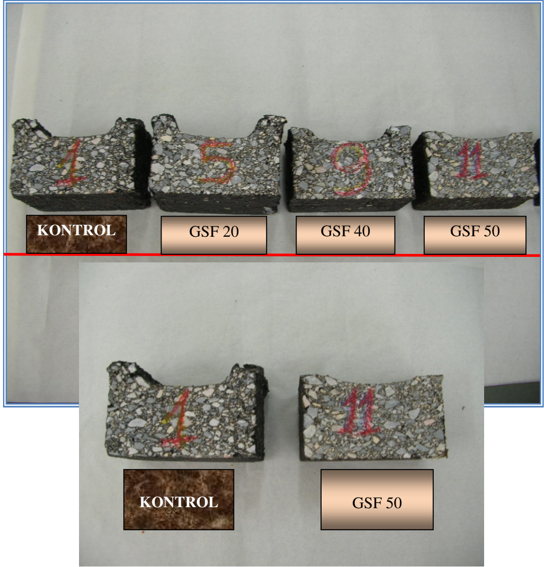
Şekil 5.33: Farklı karışım tiplerine göre tekerlek izi derinlikleri
