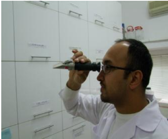
Şekil 3.15. El refraktometresi ile meyvede SÇKM ölçülmesi
