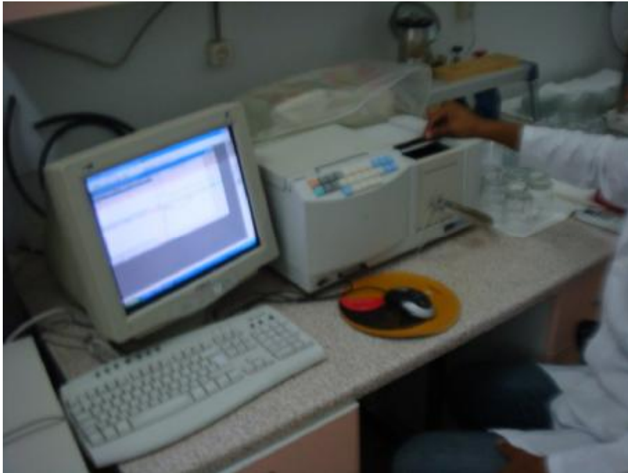
Şekil 3.16. Spektrofotometre cihazında domates meyvelerinde vitamin C analizi
