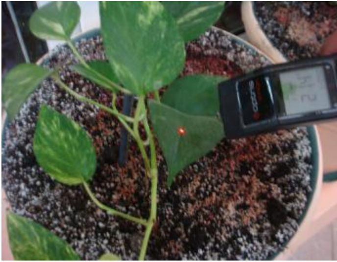
Şekil 3.12. Yaprak sıcaklığını ölçmede kullanılan infrared termometrenin görüntüsü
