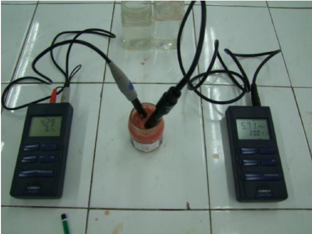
Şekil 3.17. Meyve suyunda pH (sol) ve EC (Sağ) değerlerinin belirlenmesi
