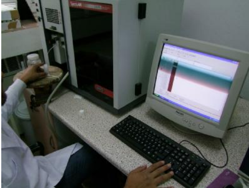
Şekil 3.13. Atomik absorbsiyon spektrofotometre cihazında K ve Ca element okumaları
