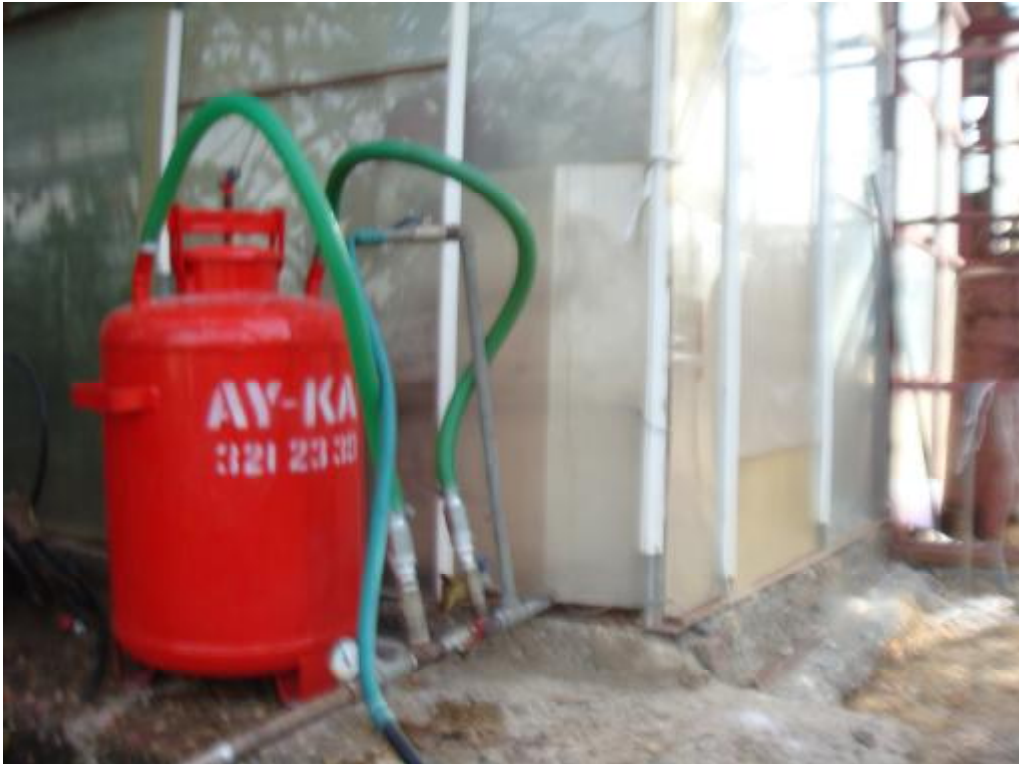
Şekil 3.6. Damla sulama sistemine bağlanan fertigasyon sisteminin görünümü
