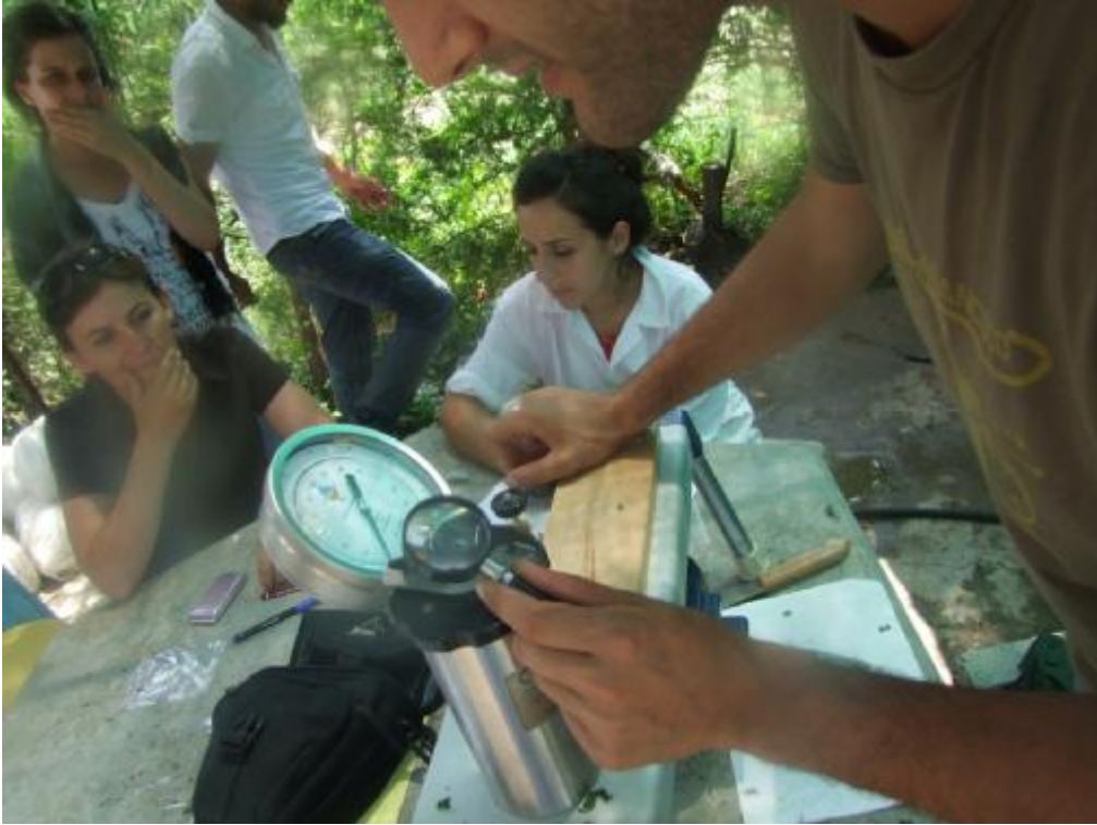
Şekil 3.10. Basınç çemberi ile yaprak su potansiyelinin ölçülmesi
