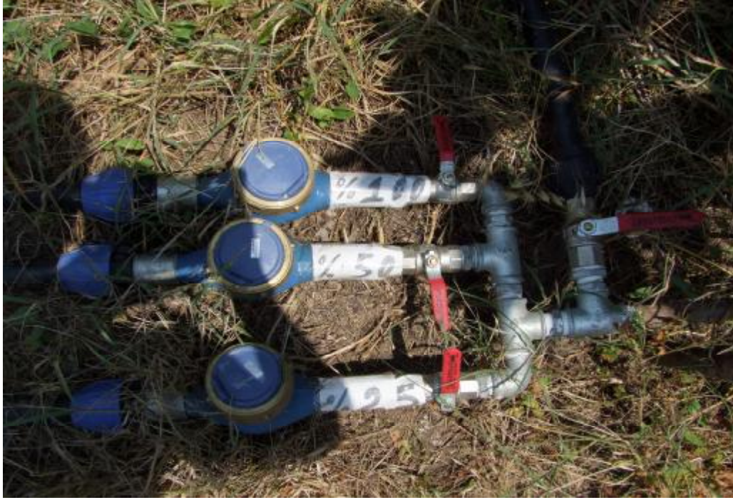
Şekil 3.5. Denemedeki 3 farklı sulama uygulamasını açıp/kapamayı kontrol eden vanalar ve uygulamalardaki sulama suyu miktarını ölçen su sayaçlarının görünümü
