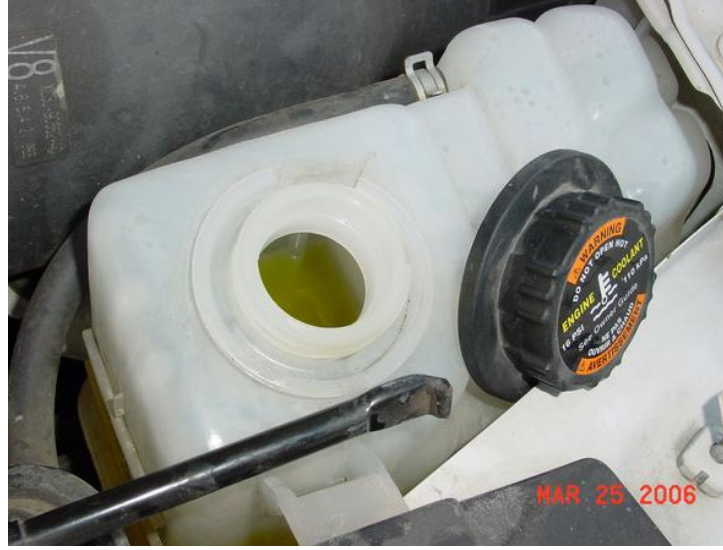
Şekil 3.5 : Taşıma kabı ve basınç kapağı örneği [10]
