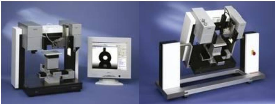
Şekil 3.1 : Krüss marka cihazı (sol) ve eğim aparatı (sağ) [7].
