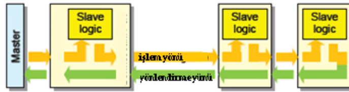
Şekil 2.5 : EtherCAT master-slave haberleşmesi.
