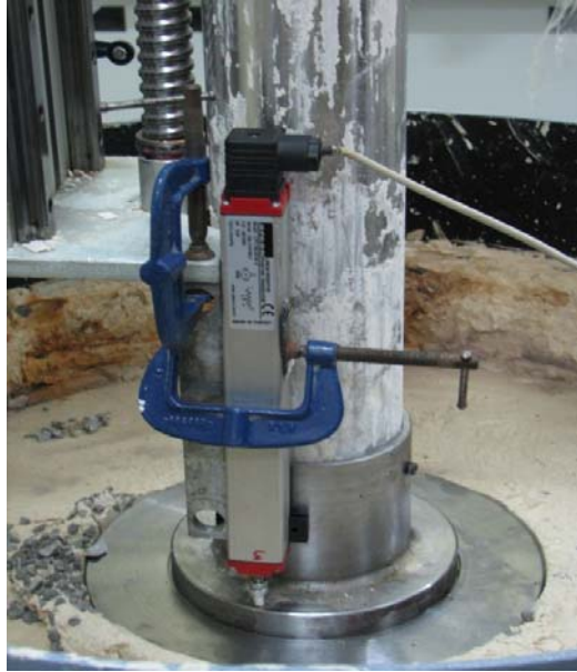
Şekil 5.15 Rezistif lineer pozisyon ölçerin konumu
