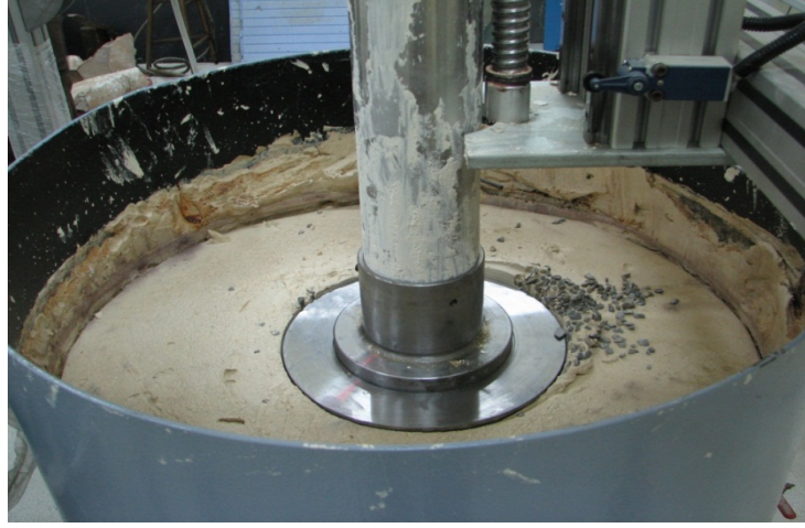
Şekil 5.14 Yükleme plakasının yerleşimi
