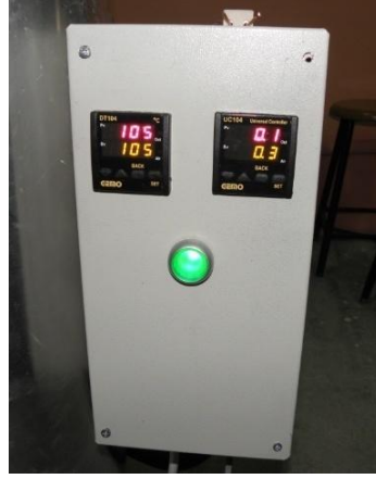
Şekil 3.4. Sıcaklık-basınç gösterge ve ayar paneli
