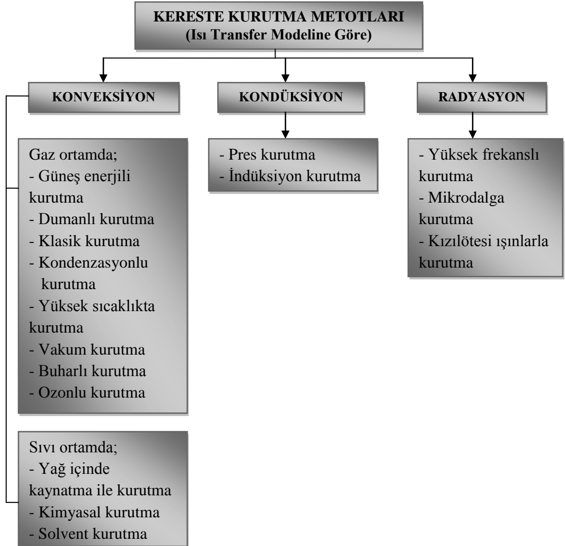
Şekil 1.8. Isı transfer şekline göre kereste teknik kurutma yöntemleri (Campean, 2010).
