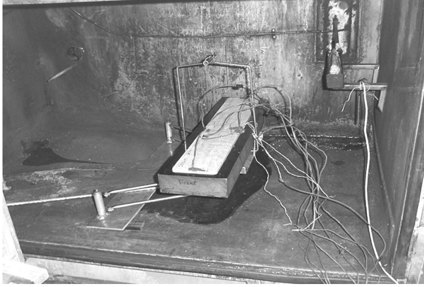
Şekil 2.6. Örnek kereste, yalıtılmış kabin ve termokupllar (Haque, 2007)
