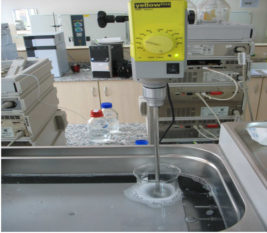
Resim 11 : KLN hazırlanması esnasında karıştırıcıda polivinilalkol çözeltisi
