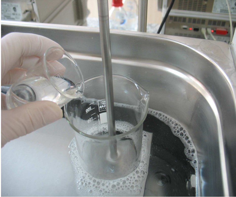
Resim 12 : SP içeren çözeltinin % 1' lik PVA çözeltisine ilave edilmesi -1
