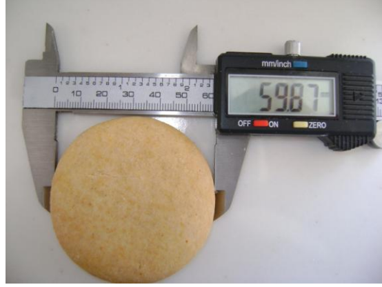
Şekil 3.6. Bisküvi genişliğinin kumpas ile ölçülmesi
