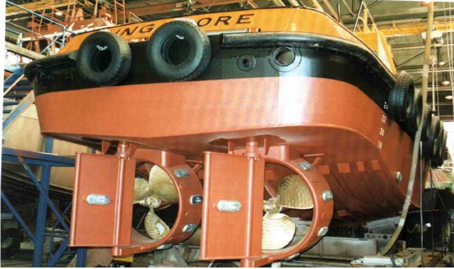
Şekil 3.3: Sabit nozullu çift uskur dümenli römorkör/çalışma botu.
