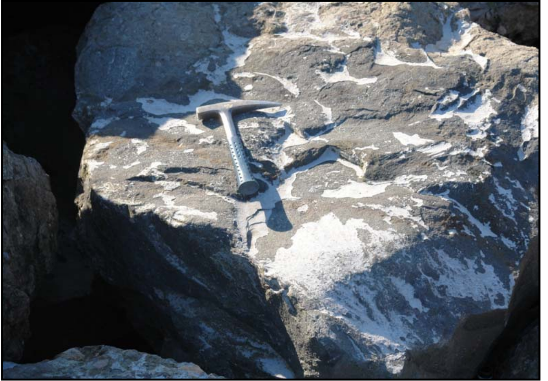
Şekil 4.18 Trabzon Limanı'nda kullanılan bazaltlarda tuzlanma
