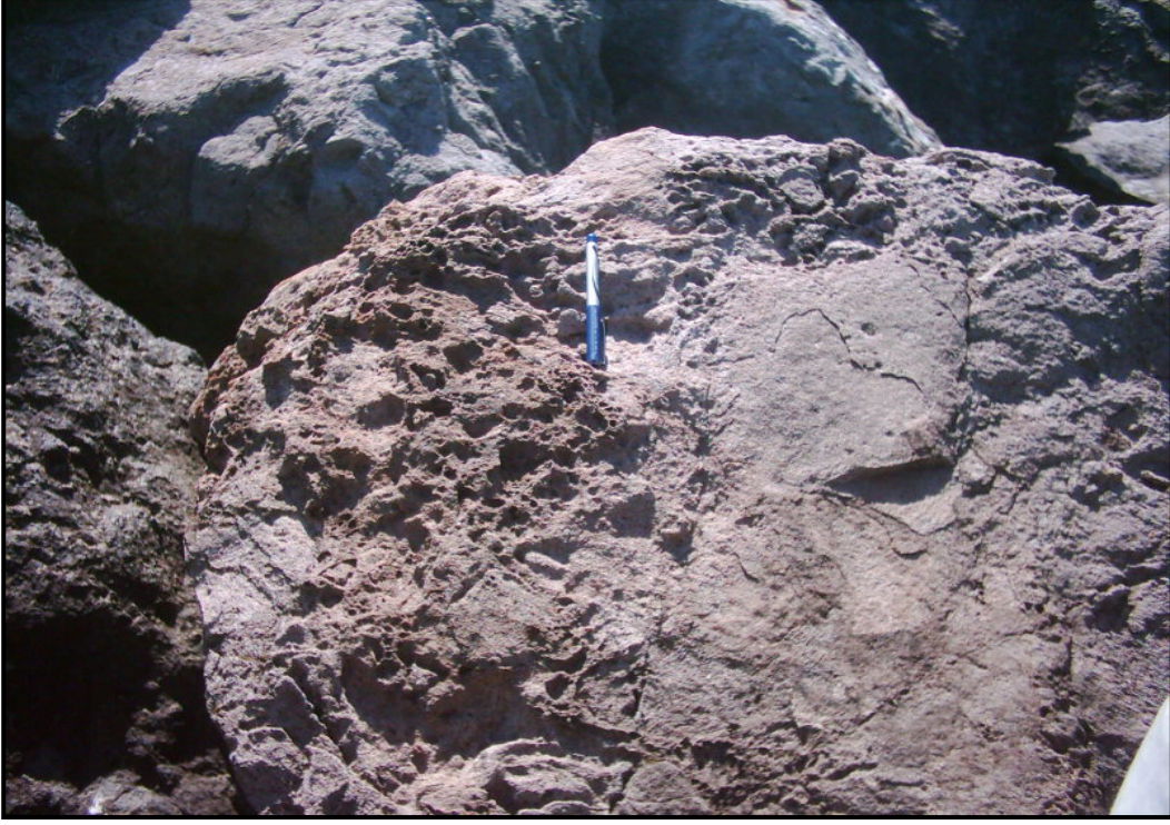
Şekil 4.7 Samsun Limanı bazaltlarında gözlenen yıkanma ve oyulmalar
