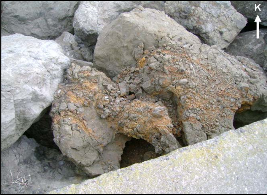
Şekil 4.8 Samsun Limanı bazaltlarında ayrışmaya bağlı oksitlenme ve ufalanma
