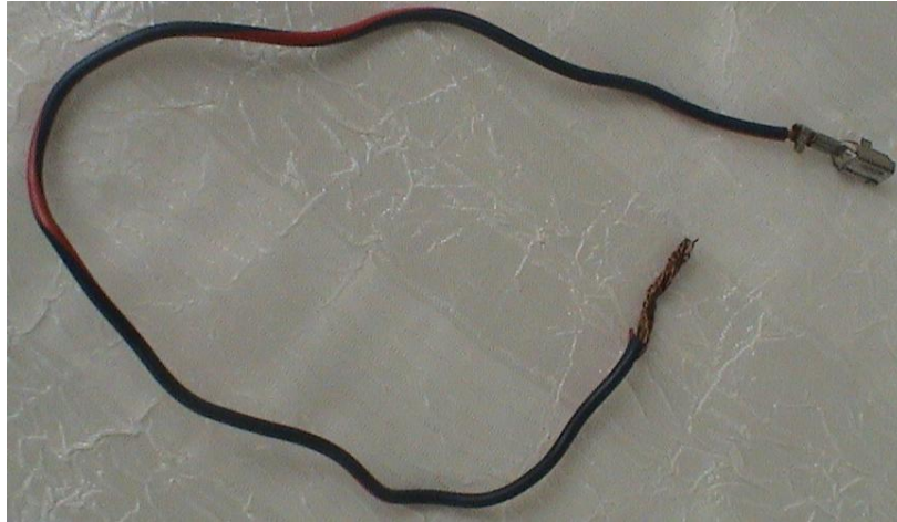
Şekil 6.4 : KST makinasında kesilmiş, uçları sıyırılmış ve tek ucu terminalenmiş kablo.
