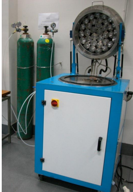
Şekil 8.7 Isıl işlem deneylerinde kullanılan RTP sistemi.
