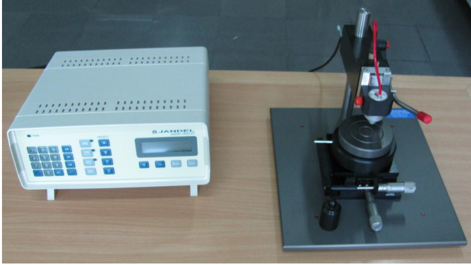
Şekil 8.8 Dört kontak test sistemini göstermektedir.
