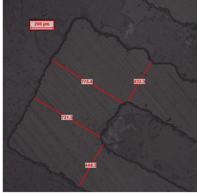
Şekil 8.36 Şekillendirme işlemi ardından alınan yüzey görüntü ve oluşturulan ince film hatların kalınlıklarını göstermektedir.
