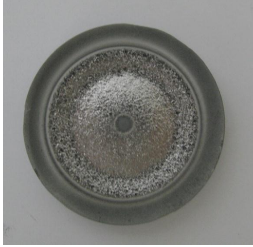
Şekil 8.6 Biriktirme işlemlerinde kullanılan Nichrome alaşım hedefi göstermektedir.
