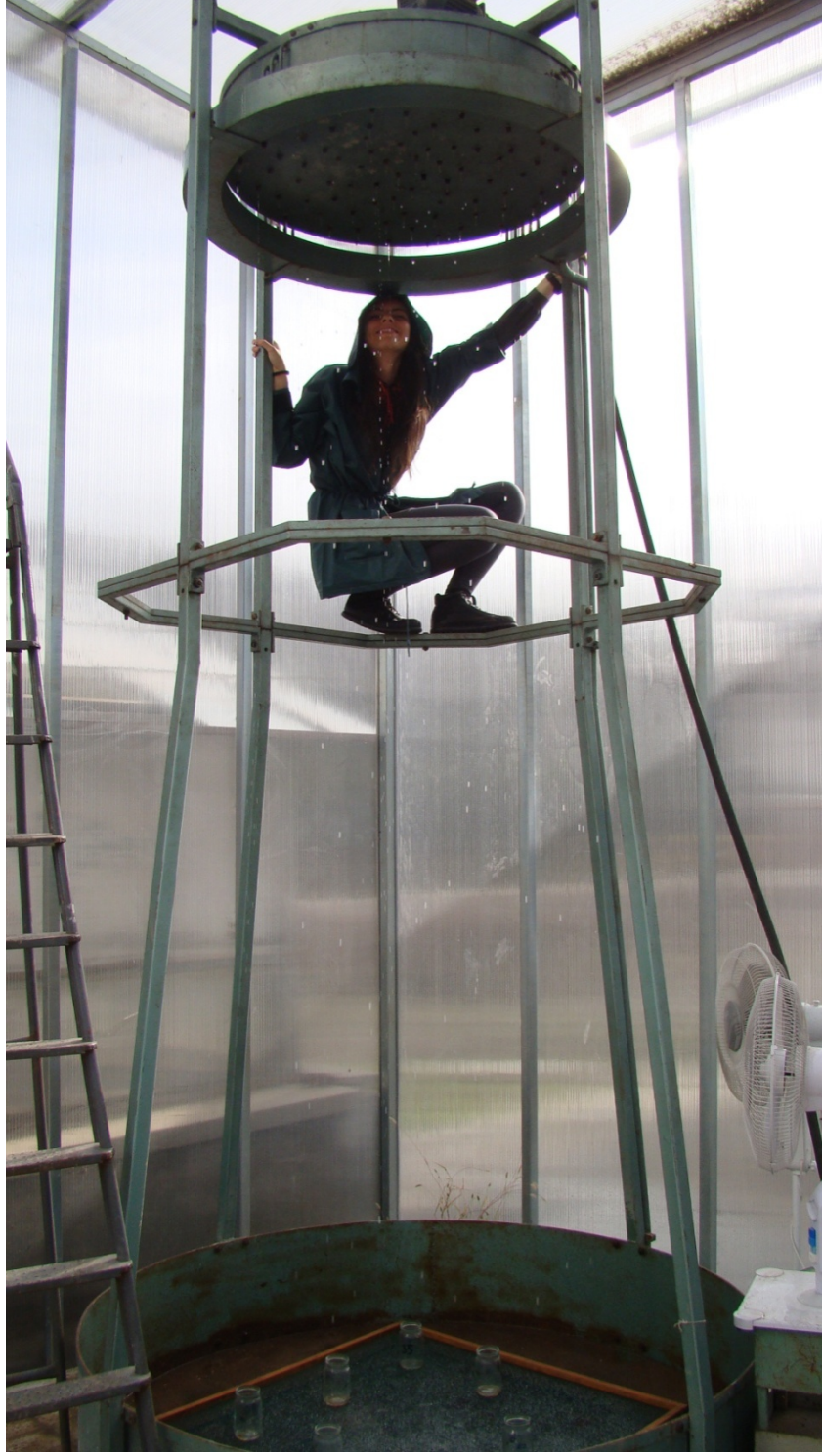
Şekil 3.6 Yapay yağmurlama aletinin genel görünüşü (Erpul ve Çanga 2001)
