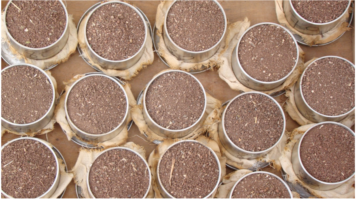
Şekil 3.9 Yağmurlama öncesi sıçrama kaplarındaki toprak örnekleri
