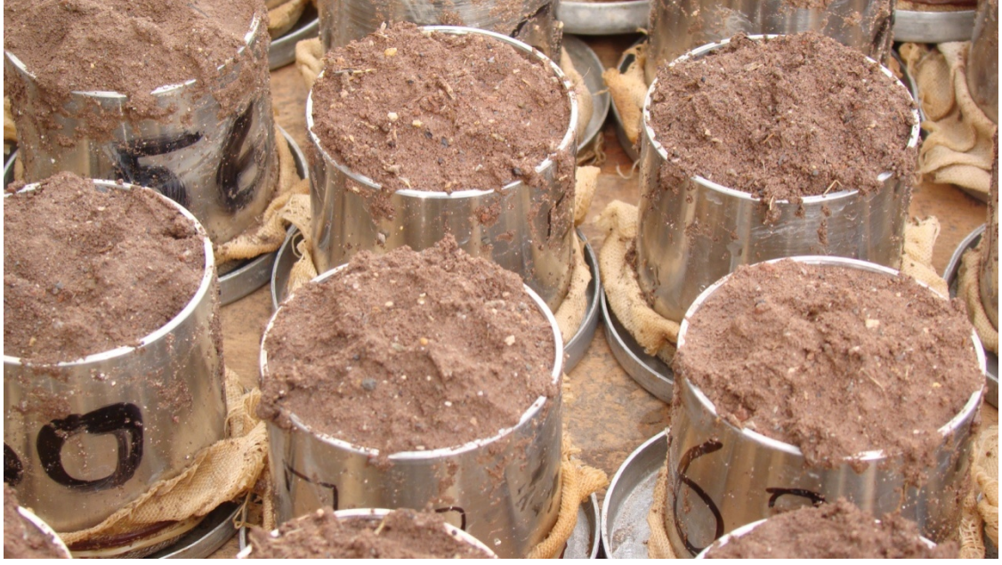
Şekil 3.12 Yağmurlama sonrası sıçrama ile kaybolan toprak taneleri
