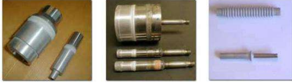
Şekil 2.9 : Kimyasal olarak birbirinden farklı malzemeleri birbirine kaynatma amaçlı yapılan SDGP kaplamalar [8].
