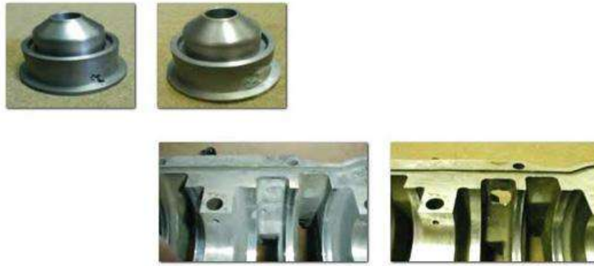
Şekil 2.10 : Parçalardaki hataların onarımı amaçlı yapılan SDGP kaplamalar [8].
