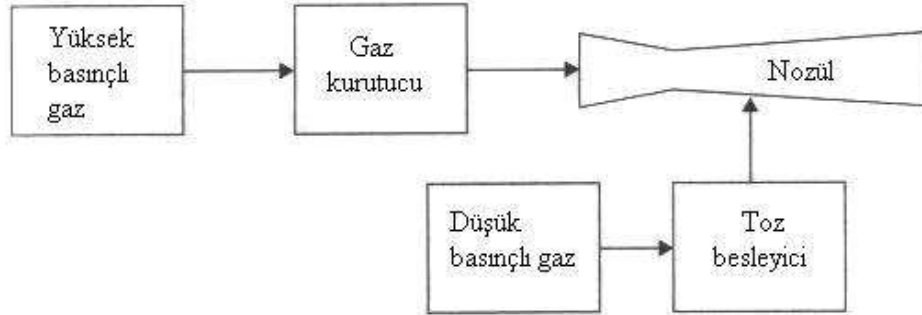
Şekil 2.3 : Portatif tip cihaz kurulumu şematik gösterimi [5].
