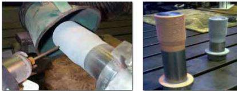
Şekil 2.11 : Gemi pervaneleri için kaymayı önleyici SDGP kaplamalar [8].
