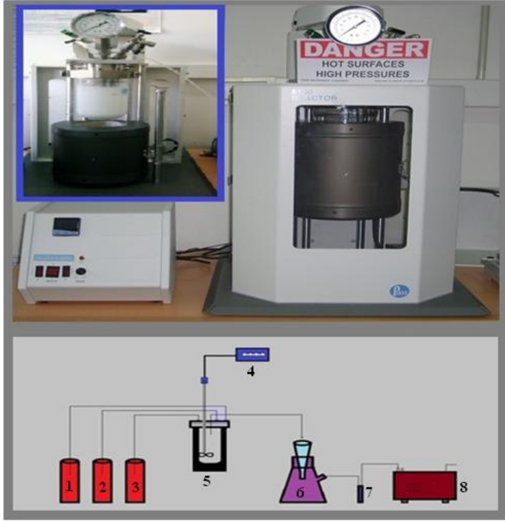
Şekil 5.3 Mekanik karıştırılmalı cam reaktör ve şematik gösterimi 1-) Borik asit, 2-) Çinko karbonat, 3-) Referans Çinko Borat, 4-) Dijital sıcaklık göstergesi, 5-) Ceketli cam reaktör, 6-) Katı-sıvı faz ayırma aparatı, 7-) Tuzak, 8-) Vakum pompası
