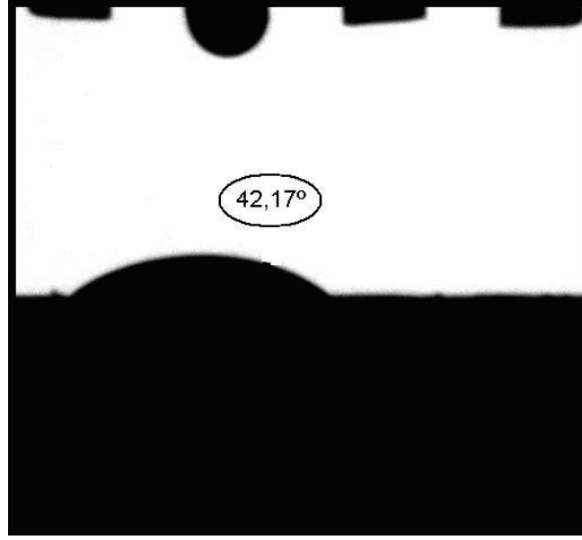
Şekil 6.124 Kerosen-İPA karışımı ile optimum noktalarda elde edilen hidrofobik Çinko Boratın temas açısı değeri ve görüntüsü (Deney koşulları: 2 saat, H_3BO_3:ZnCO_3 : [4:1], % 0.5 aşısı, % 2 kerosen, 4 ml İPA, 95°C, 500 rpm)
