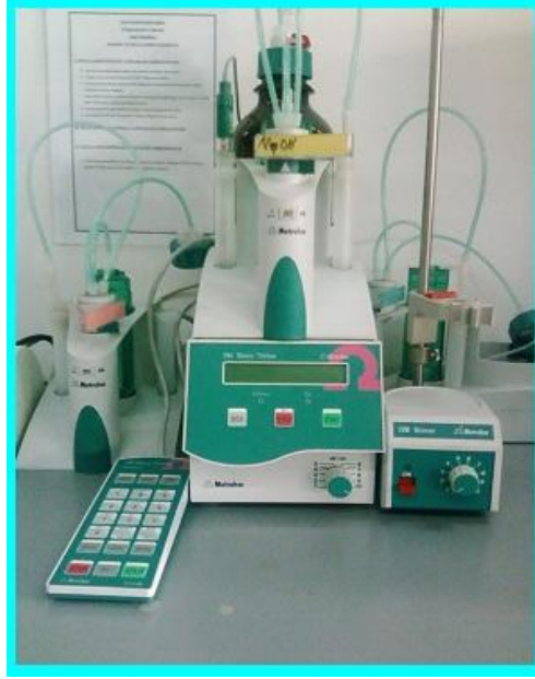
Şekil 5.4 Potansiyometrik titrasyon cihazı
