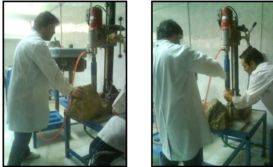
Şekil 5.4 Alınan blok numunelerinden A.Ü. Jeoloji Mühendisliği Bölümü Zemin Ve Kaya Mekaniği Laboratuvarı’nda karot numunesi çıkarılma işlemleri
