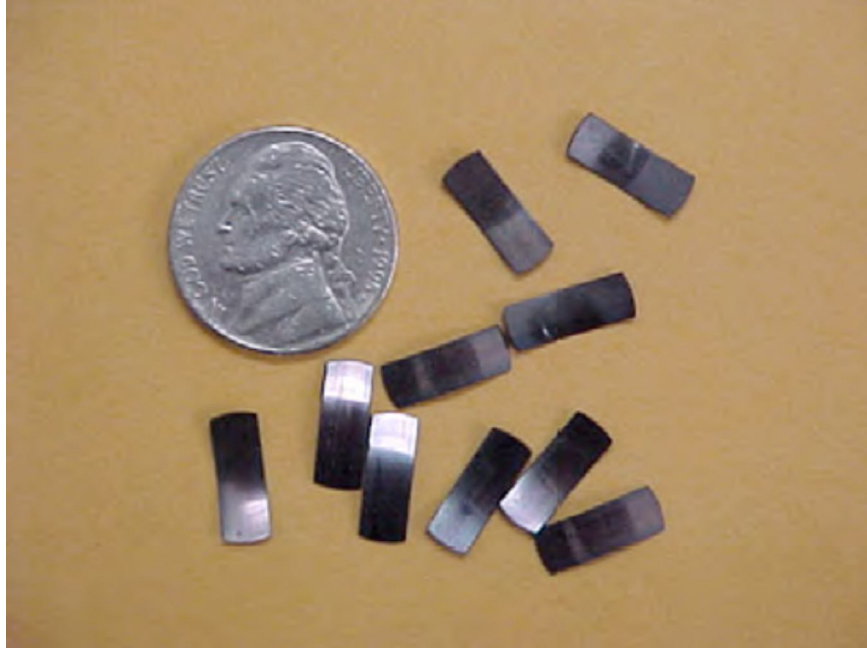
Şekil 2.24. Emniyet vanası olarak kullanılan NiTiCu çalıştırıcılar [53].
