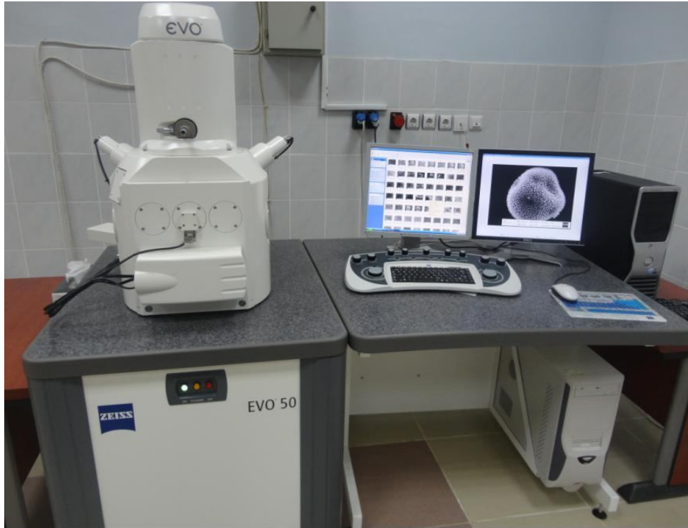
Şekil 3.6. Taramalı elektron mikroskobu (SEM) ve EDS analiz cihazı
