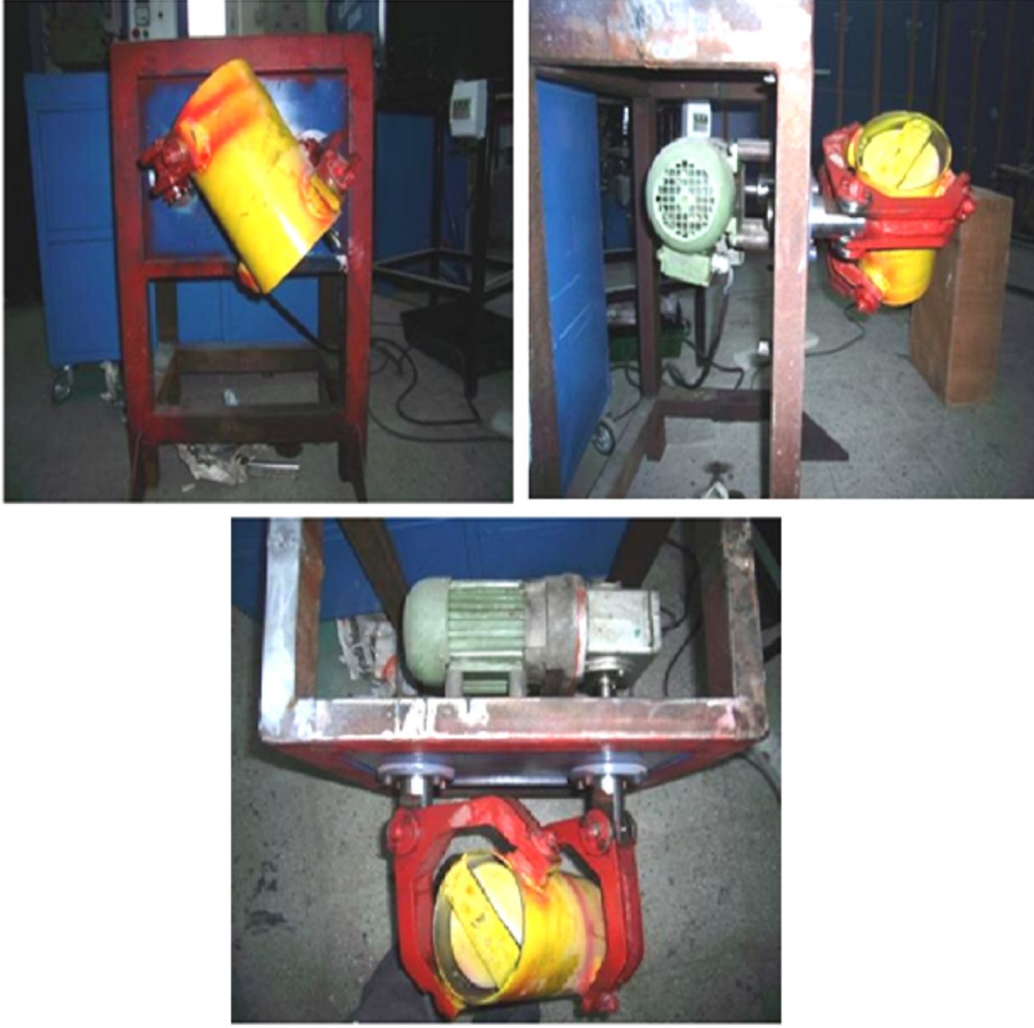
Şekil 3.1. Numunelerin üretiminde kullanılan 88-tipi mikserin yan, üst ve ön görünüşü
