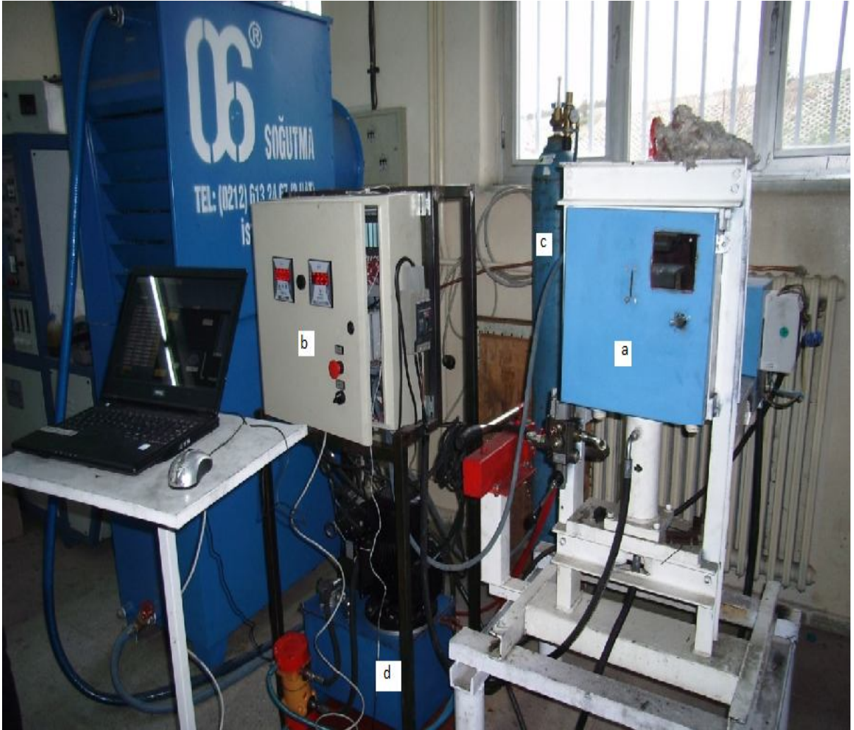
Şekil 3.2. Sıcak presleme makinesi üniteleri: a) Argon gazı atmosferindeki presleme kabini, b) Otomasyon Panosu, c) Argon gazı tüpü, d) Hidrolik basınç üreten asenkron elektrik motoru
