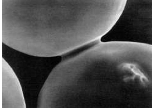
Şekil 2.18. Toz taneciklerinin birleşmesini gösteren SEM görüntüsü [34].
