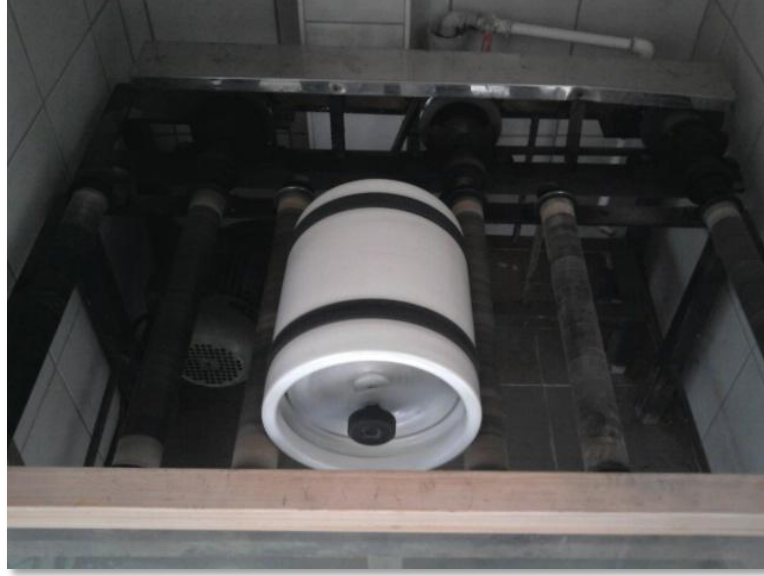
Şekil 3.2 Çalışmada kullanılan bilyeli değirmen
