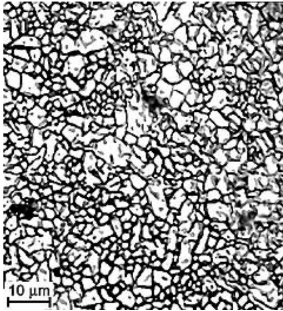
Şekil 2.7 : Mikro kristalin alüminyum oksit mikro yapısı
