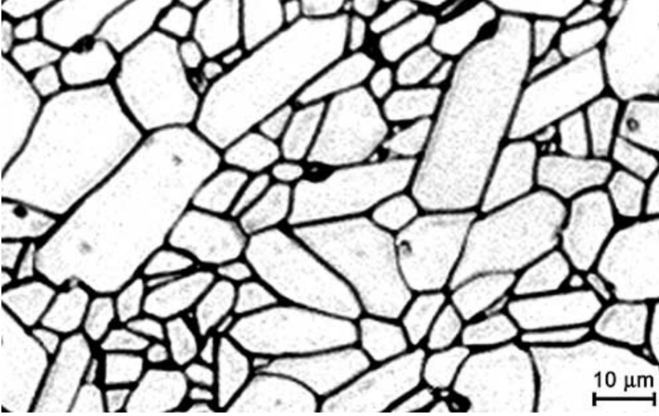
Şekil 2.6 : % 99.7'lik alüminyum oksit seramiği mikro yapısı
