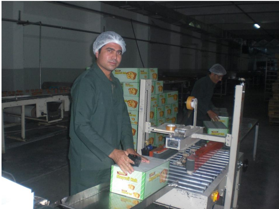
Şekil 4.14. 2. Hatta koli bantlama makinesinin kullanımı
