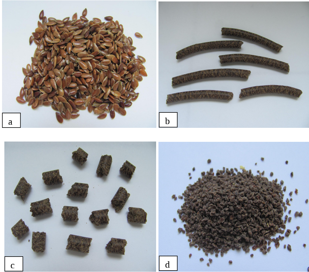
Şekil 11. Kritik altı su ekstraksiyonu çalışmasında materyal olarak kullanılan keten tohumu ve keten tohumu küspesi fotoğrafları. a: tane keten tohumu, b: keten tohumu küspesi, c: parça küspe, d: öğütülmüş küspe
