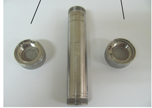
Şekil 15. Ekstraksiyon işleminin yapıldığı metal hazne ve başlıkları
