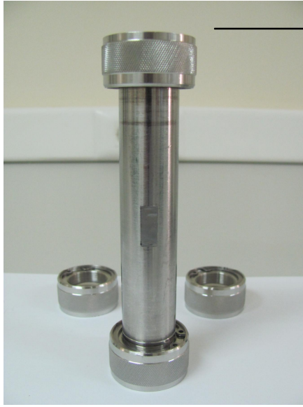
Şekil 15. Ekstraksiyon işleminin yapıldığı metal hazne ve başlıkları
