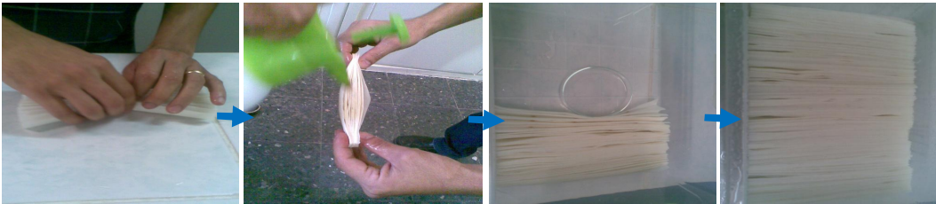
Şekil 7. Keten tohumlarını ön ıslatma ve sandviç kaplara yerleştirme aşaması
