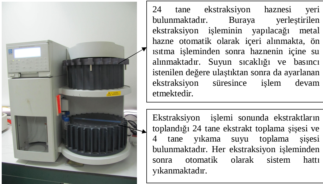
Şekil 13. ASE 200 cihazında ekstraksiyonun gerçekleştiği ve ekstraktların toplandığı kısımlar
