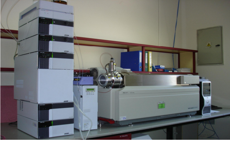
Şekil 17. LC-MS/MS (Sıvı kromatografisi- İkili Kütle Spektrometresi) cihazının (API 4000 model) fotoğrafı
