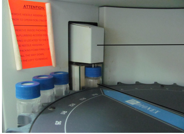
Şekil 14. ASE 200 cihazında otomatik ekstrakt boşaltma kısmı ve ekstrakt toplama vialı
