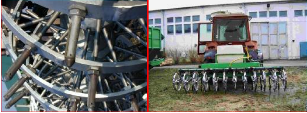
Şekil 2.3. Enjeksiyon gübrelemede kullanılan çark şeklindeki enjektör ve makinel
