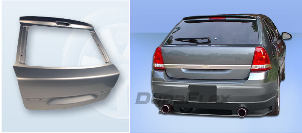
Şekil 6.20 : Chevrolet Malibu Maxx alüminyum bagaj kapağı [45]
