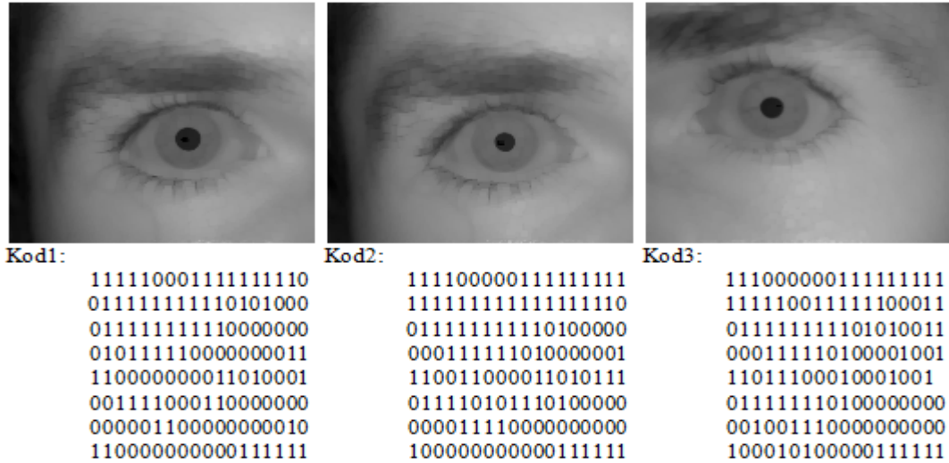
Şekil 3.5: 18 açısal ve 8 yarıçapsal bölge seçilmesi durumunda örnek imgeler için elde edilen ikili iris kodları
