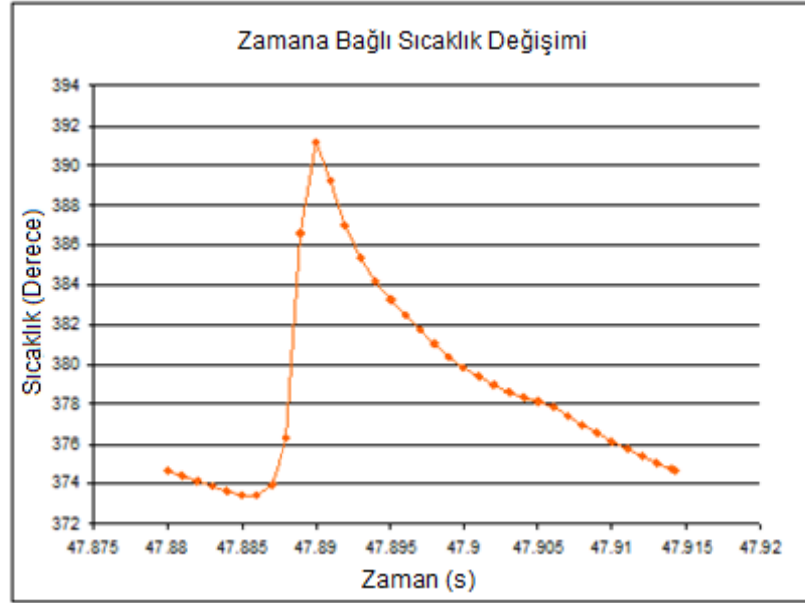
Şekil 1.7 : Zamana bağlı olarak değişen yanma odası sıcaklığı.
