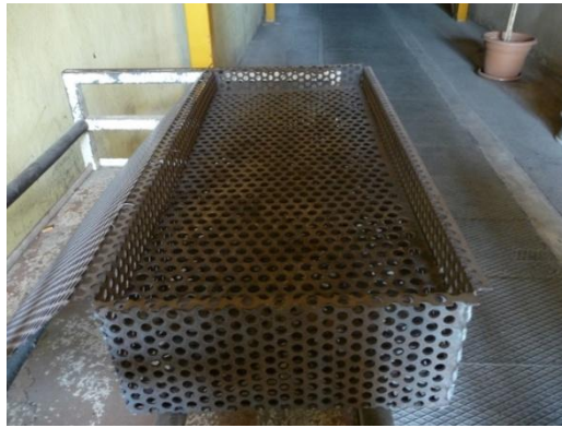
Şekil 3.10 : Isıl işlem numune kafesi.
