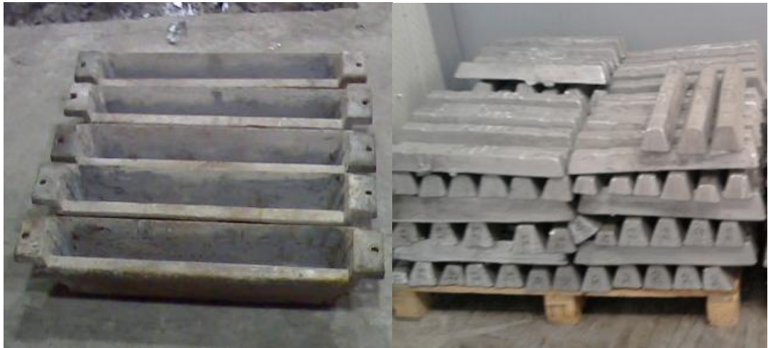
Şekil 4.10 : Master alaşım kalıpları ve 32 adet deney çıktısı külçeler.
