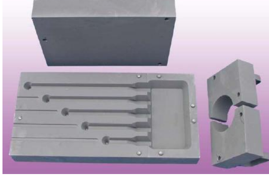
Şekil 3.6 : Sıcak yırtılma kalıbı.
