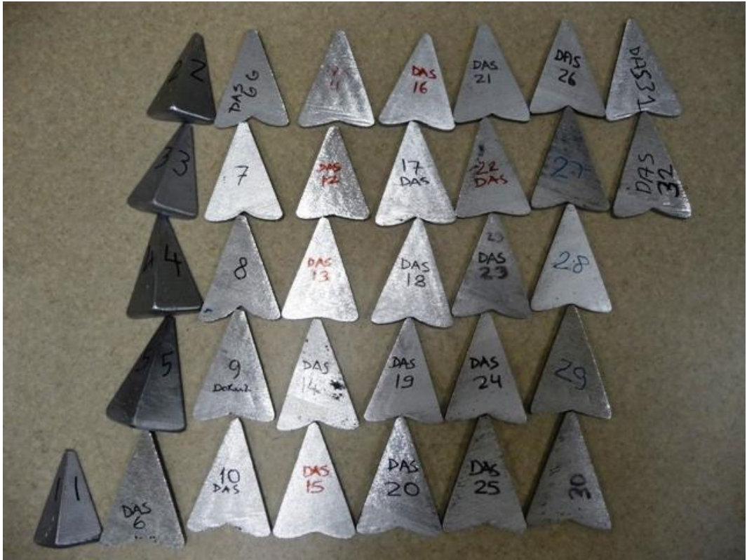
Şekil 4.32 : DAS kalıbı numuneleri döküm hali (yüzey hazırlama öncesi).
