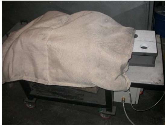
Şekil 4.5 : Metal Health sistemi ısıtılmasında kullanılan yalıtım battaniye görüntüsü.
