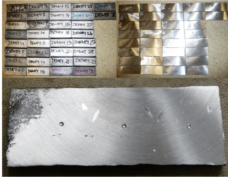
Şekil 4.30 : Sertlik ölçümü yapılan 32 adet numune.
