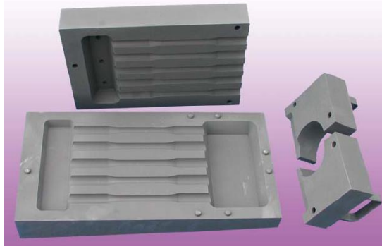
Şekil 3.7 : Çekme testi kalıbı.
