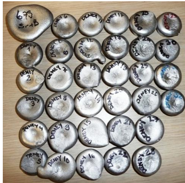
Şekil 4.4 : Spektrometre döküm numuneleri.
