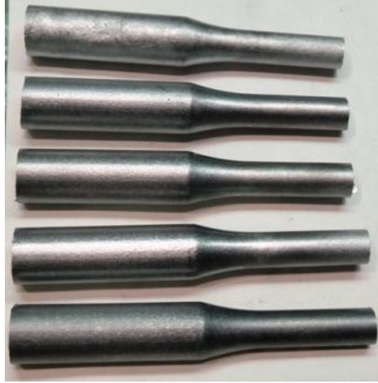
Şekil 4.22 : Metal Health işlenmemiş çekme çubukları (tornalama öncesi).
