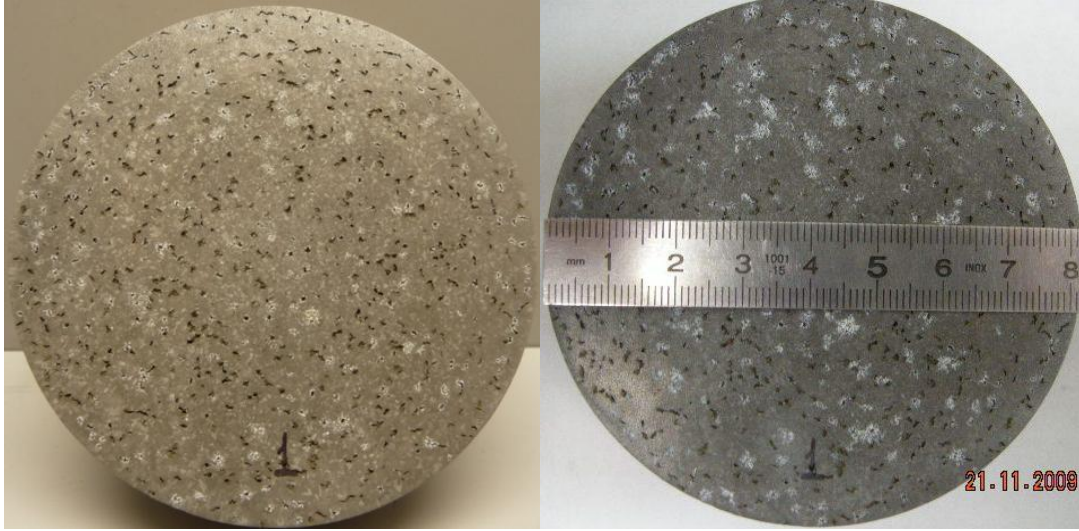
Şekil 4.37 : % 7 Si içeren 1 nolu alaşımın makro yapısı.
