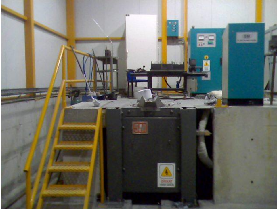
Şekil 3.2 : 5M alüminyum indüksiyon ocağı.
