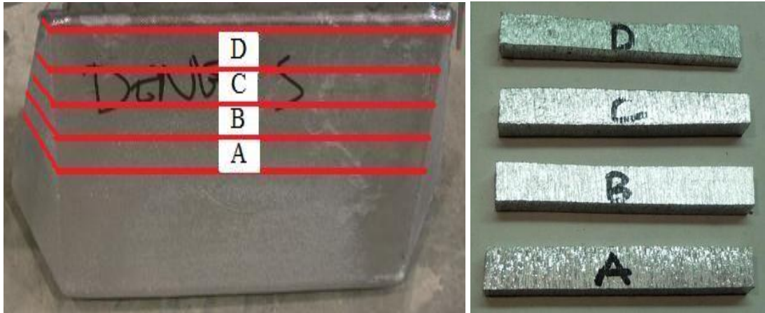
Şekil 4.23 : DAS çekme çubuğu kesit bölgeleri ve ham çekme çubukları.
