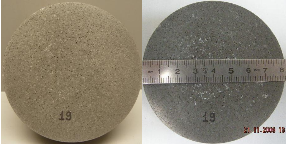
Şekil 4.56 : % 4 Si içeren 19 nolu alaşımın makro yapısı.
