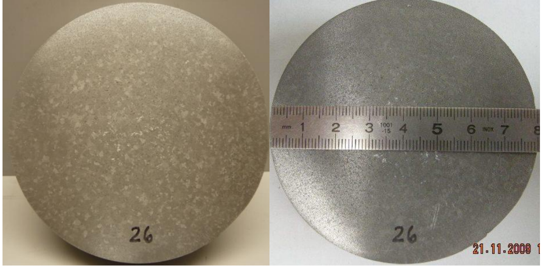
Şekil 4.63 : % 7 Si içeren 26 nolu alaşımın makro yapısı.
