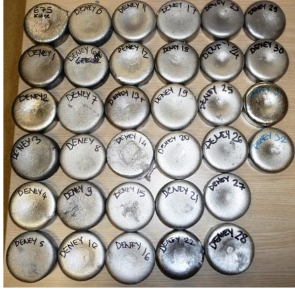
Şekil 4.3 : Makro döküm numuneleri.
