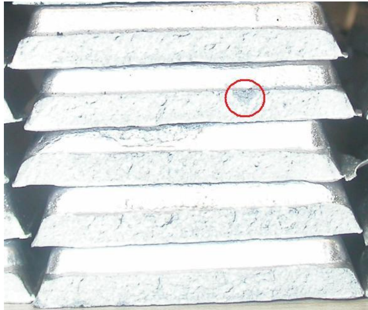
Şekil 4.13 : K-testi örnek inklüzyon görünümü.
