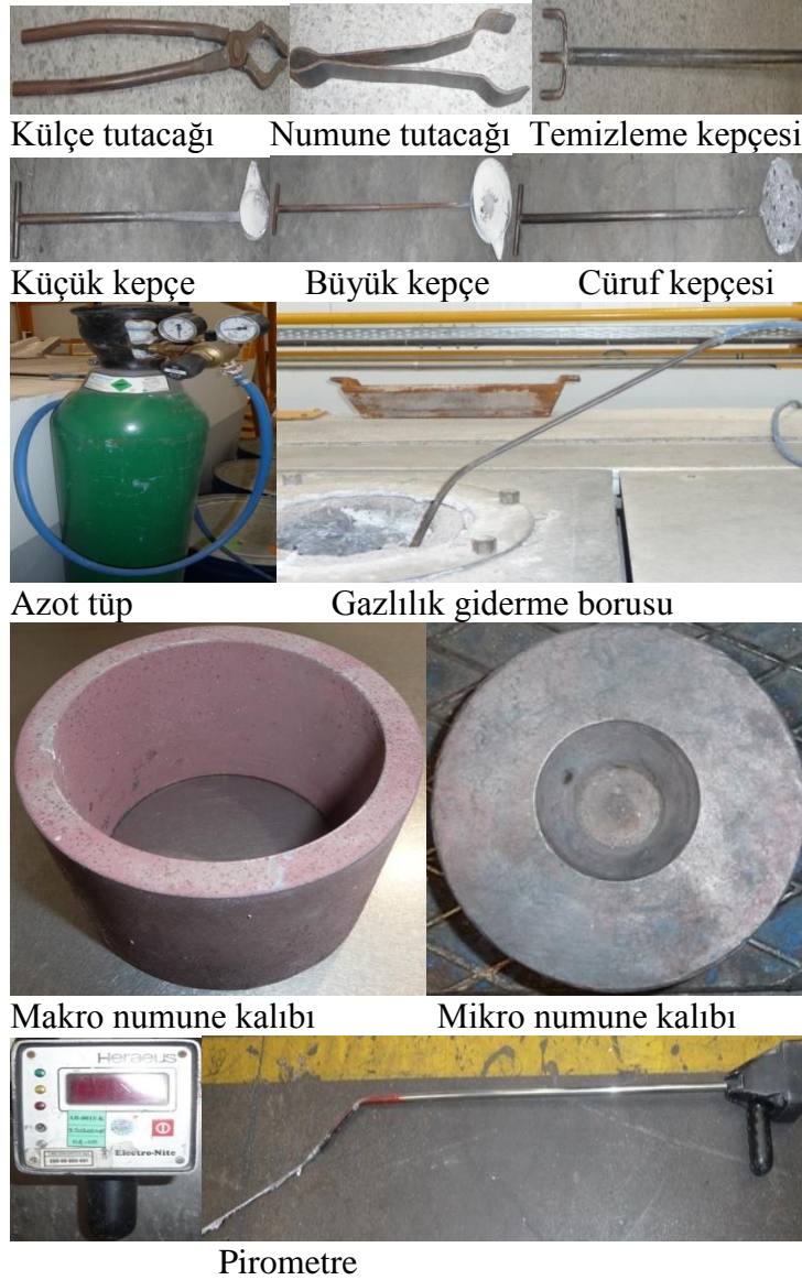
Şekil 3.3 : 5M İndüksiyon ocağı yardımcı ekipmanlar.
