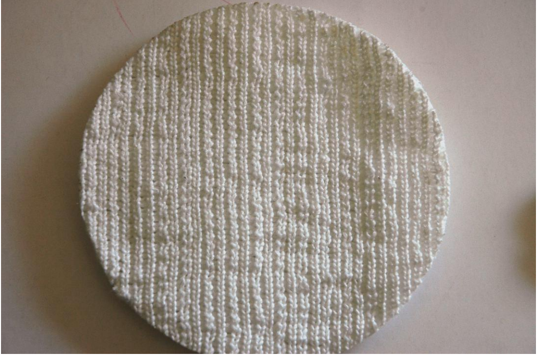
Şekil A.24 : Büyük tüp için kullanılan numune örneği (50 Hz- 1,6 kHz).
