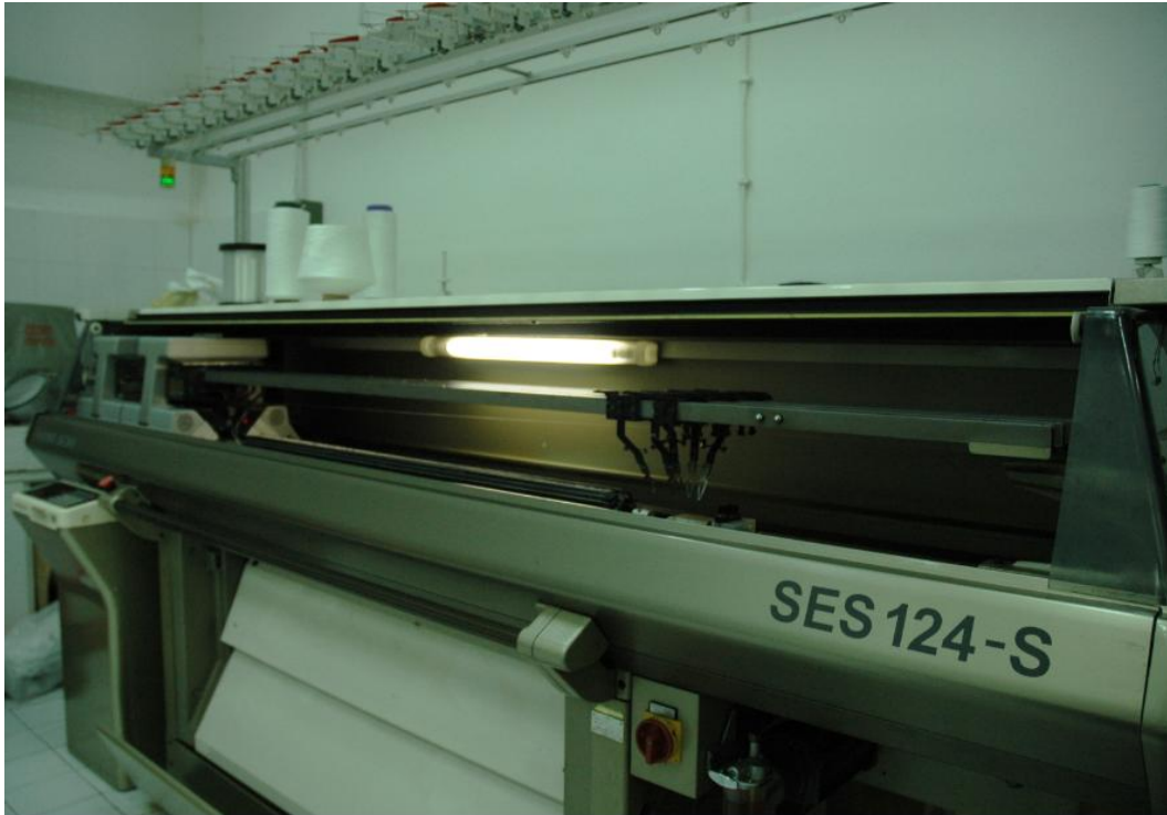
Şekil 5.4 : Shima Seiki SES 124S marka V yataklı düz örme makinesi.
