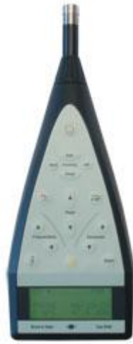
Şekil 2.6 : Ses düzey ölçer.
