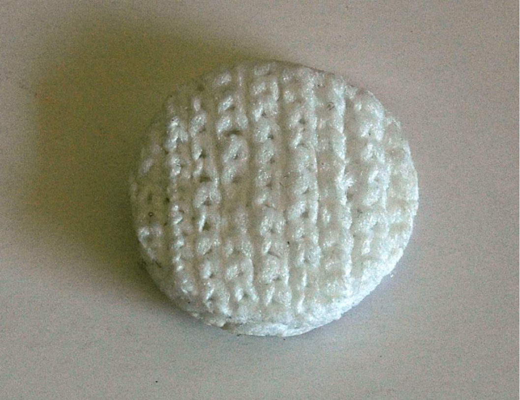
Şekil A.25 : Küçük tüp için kullanılan numune örneği (1,6 kHz- 6,4 kHz).
