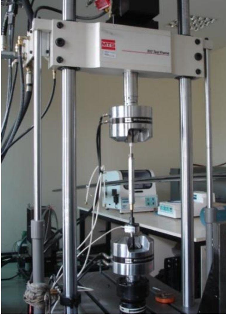
Şekil B.1 : Hidrolik damper test düzeneği.
